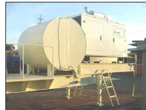
Motor Stemac com motor Cummins
