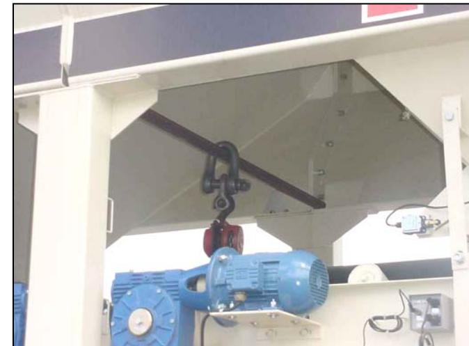
Passe a cinta de levantamento na extremidade inferior da correia. (Cuidado para não danificar a esteira).
