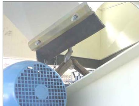
Após a montagem da moega de descarga inferior, será necessário re-alocar a cinta de levantamento para que esta passe por dentro da moega.
