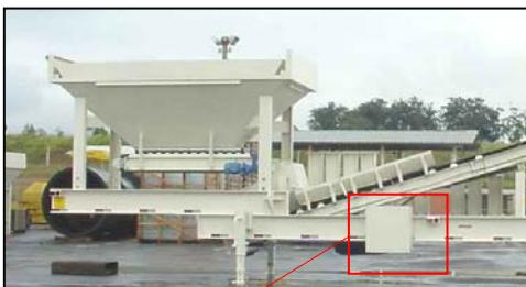
Caixa de conexões elétricas do cj. de reciclagem
