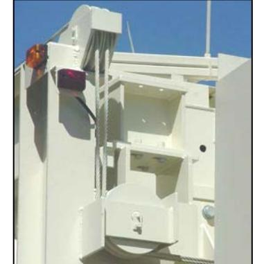
d) Acione a central hidráulica através do sistema remoto de comando, e levante o silo até sua posição máxima. Lembre que o sistema de intertravamento somente autoriza esta operação quando o elevador estiver totalmente levantado.
