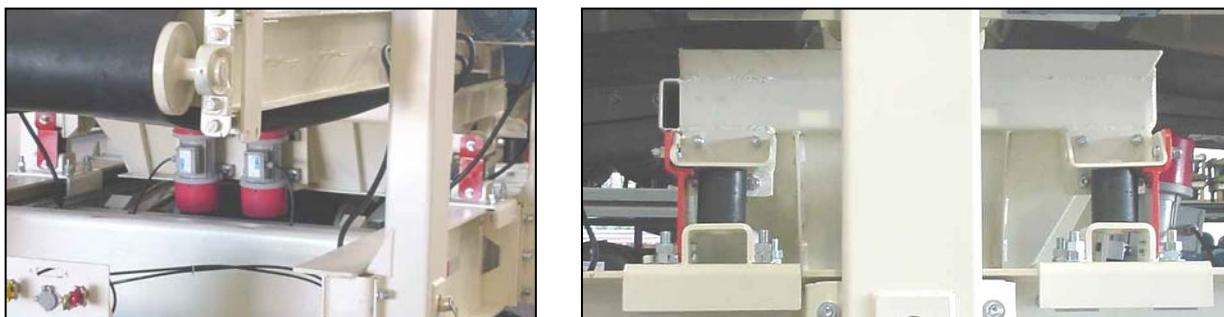
Retire as travas da moega (peças pintadas em vermelho). Guarde estes dispositivos para quando for transportar o equipamento.
