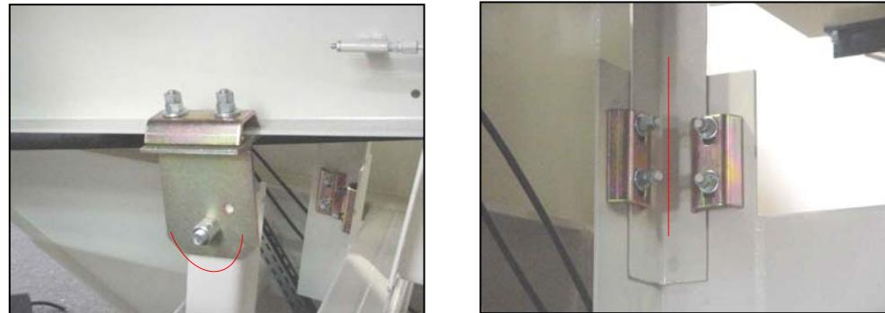
Estes suportes permitem uma ampla gama de ajustes de altura e regulagem do ângulo para fixação.
