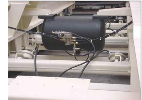
Cuando el equipo tenga que estar estacionado (o por ejemplo, para transporte en navíos), se debe siempre accionar el freno de estacionamiento. Esto debe hacerse manualmente.
