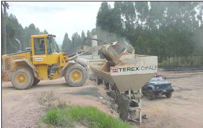
Descarregamento adequado de material no silo.
