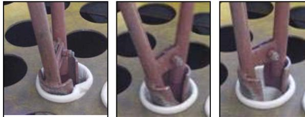
**Passo 07** Com o auxílio do dispositivo 34068118, force o colarinho até que este fique perfeitamente amoldado ao furo.
