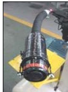
A cada três dias, remova todo o elemento filtrante e limpe-o com ar comprimido.
