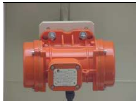
Detalhe da montagem do vibrador
