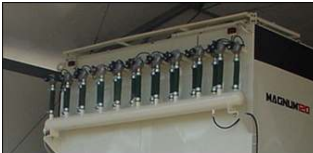
Reservatório suplementar – Usina Magnum 120
