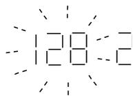
O display mostra que, no parâmetro 128 *Proteção térmica do motor*, a seleção feita é *Desarme por termistor* [2].
