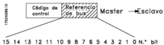
El valor de referencia de la frecuencia se transmite al convertidor de frecuencia VLT en forma de un código de 16 bits. El valor se transmite como un número entero (-32767 • 32767). Las cifras negativas se forman por medio del complementario de 2.
