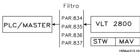
Los parámetros 834 a 837 pueden utilizarse para filtrar los eventos no deseados para COS. Si un bit de filtro se fija en 0, el bit de instancia de E/S correspondiente no podrá generar un mensaje de cambio de estado.
