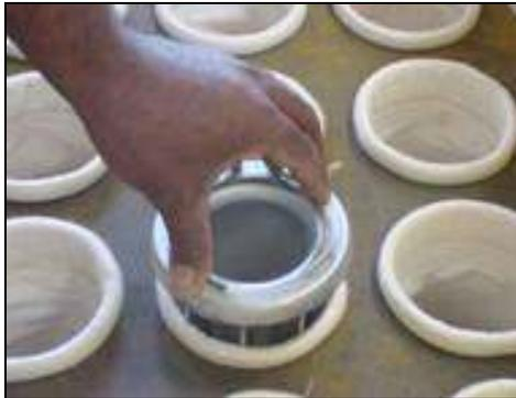
**4º PASO:** retire las mangas del filtro, estirando la misma por el alza localizada en la parte interna de la misma.
