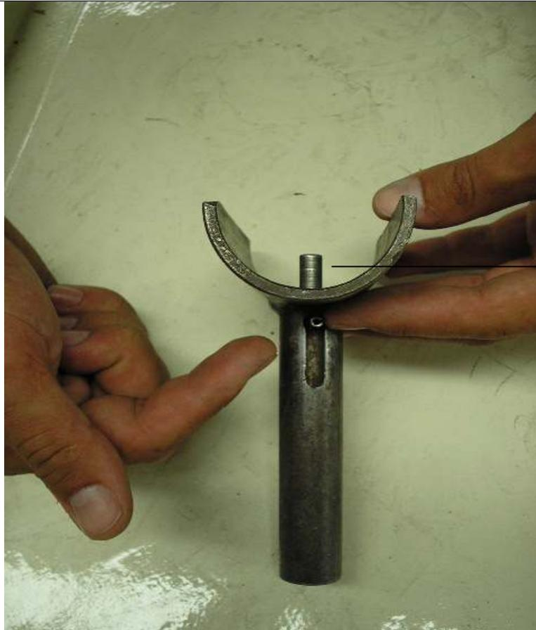
Dispositivo utilizado para centralización entre la flauta y la manga.
