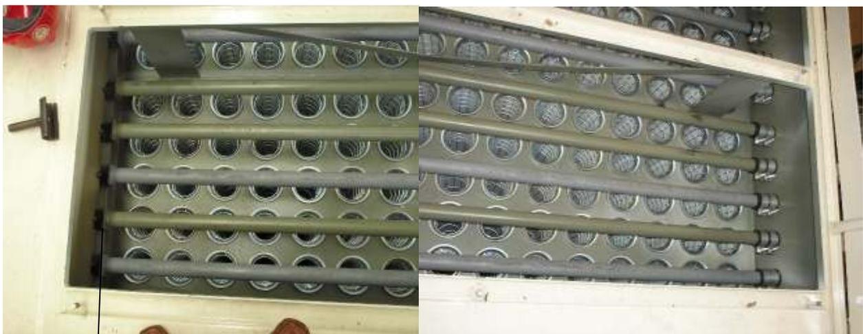
Para remover las flautas del filtro de mangas, afloje los tornillos de fijación.
