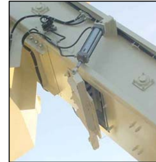
Comporta de descarga de emergência (E) Emergency discharge gate
