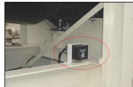
Localização do sistema de liberação no chassi. (E) Location of the brake release system.
