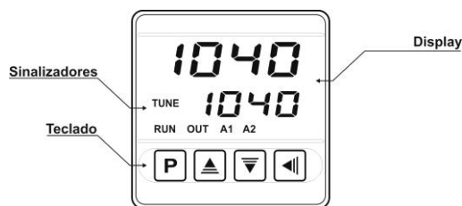
Figura 02 - Identificação das partes do painel frontal
