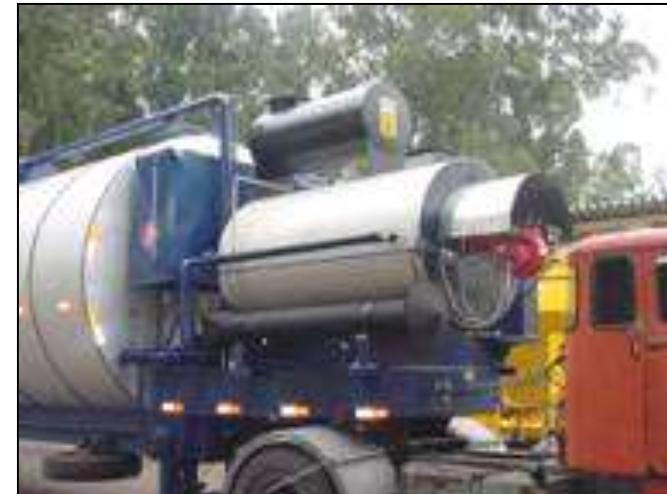
Aquecedor incorporado em sistema de tancagem móvel
