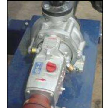
**TAMANHO:** A bomba é selecionada de acordo com a vazão de óleo necessário para garantir a potência térmica de cada aquecedor, tendo portanto tamanhos diferenciados de acordo com o modelo do aquecedor, com pressão suficiente para garantir a circulação do óleo dentro de todo o sistema (Aquecedores, redes e consumidores) térmico do usuário:
