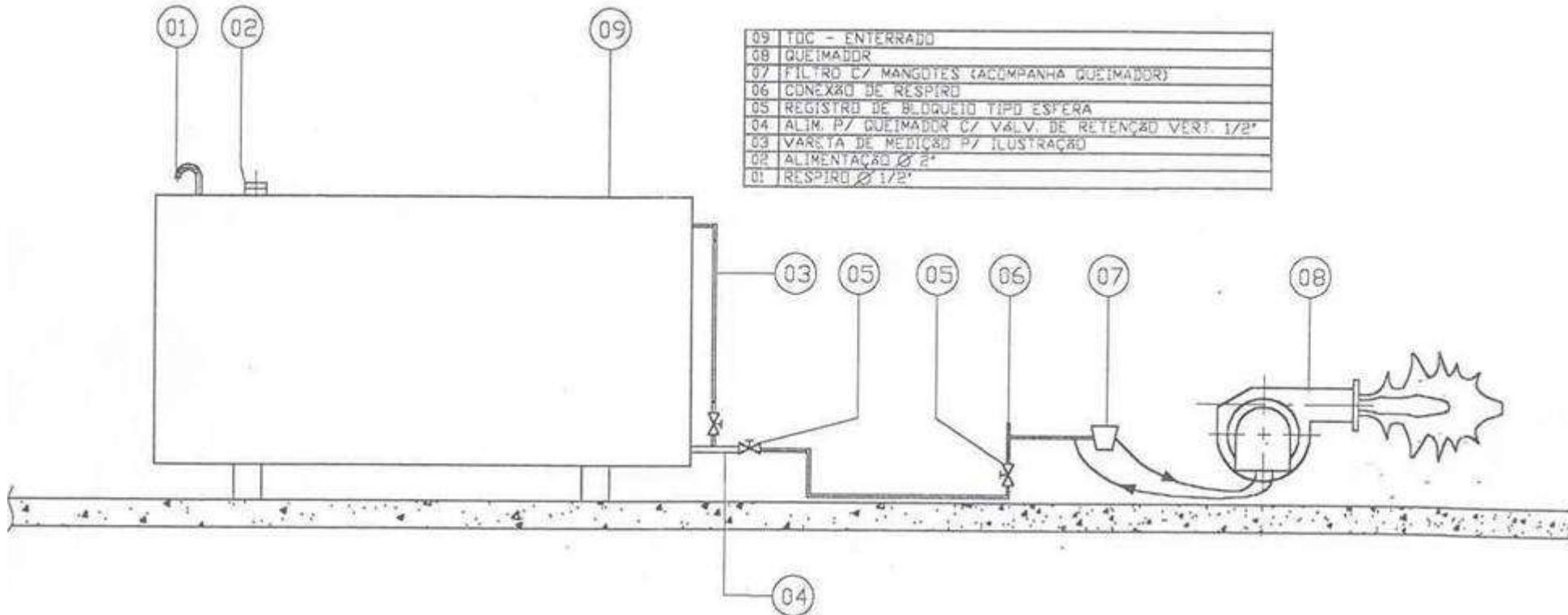
**Tanque Enterrado:** O tanque de óleo pode ser enterrado, sendo recomendado neste caso a montagem de uma bomba de transferência do óleo desde o reservatório até o tanque de serviço do aquecedor. Ver desenho CFT-H-02-M.
