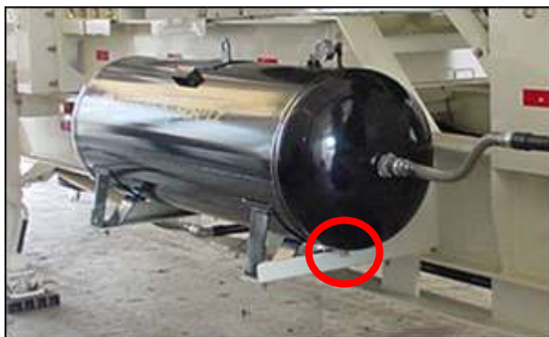
Válvula de purga del depósito de aire
