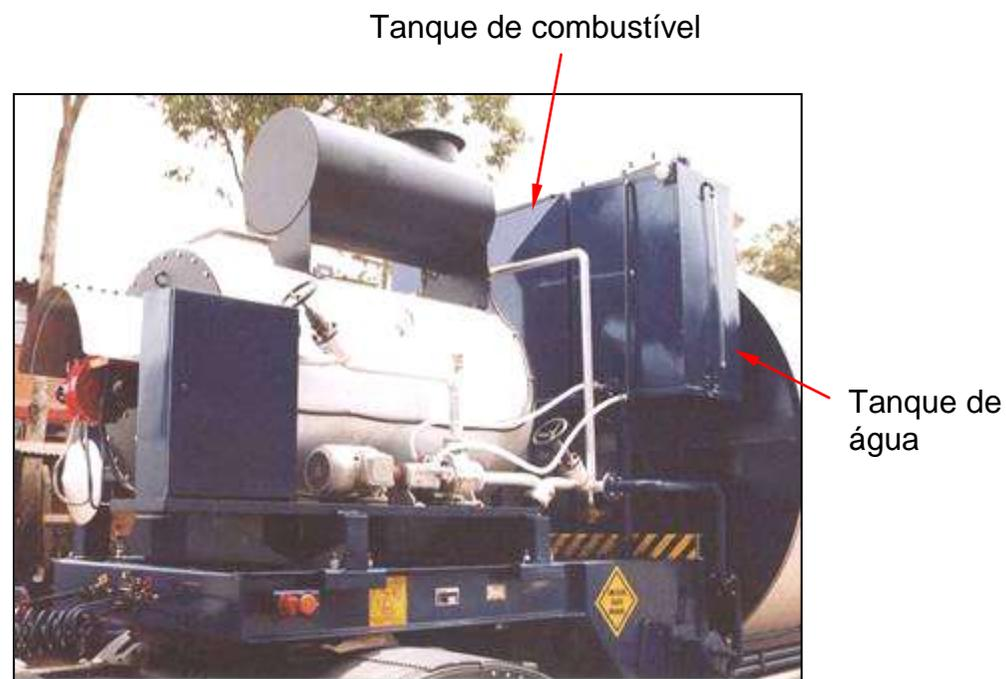
**Tanque Externo:** O tanque de óleo pode ser externo aparente, sendo recomendado sua montagem em nível mais alto que ao aquecedor para permitir o escoamento por gravidade do óleo até o queimador.
