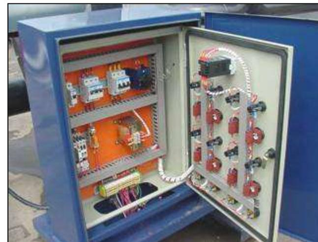
**AQUECEDORES MOVEIS:** Nestes modelos o painel de comando está fixado sobre a mesma base da bomba de circulação do fluido, localizada no lado direito do conjunto, de forma afastada do corpo para reduzir a influência do calor desta para o quadro, eliminando os riscos de superaquecimento.
