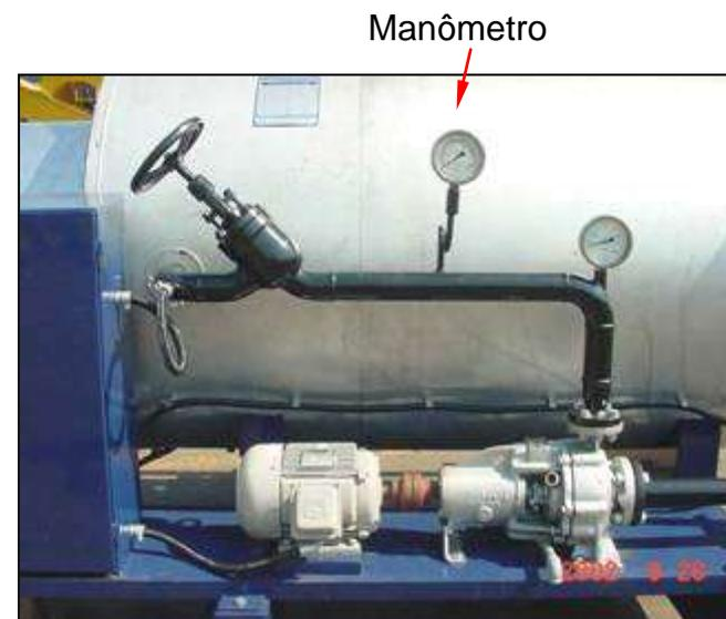
**REDUÇÃO** da pressão pode ser redução do fluxo de óleo que pode ser por desgaste no rotor da bomba ou filtro de óleo excessivamente sujo.
