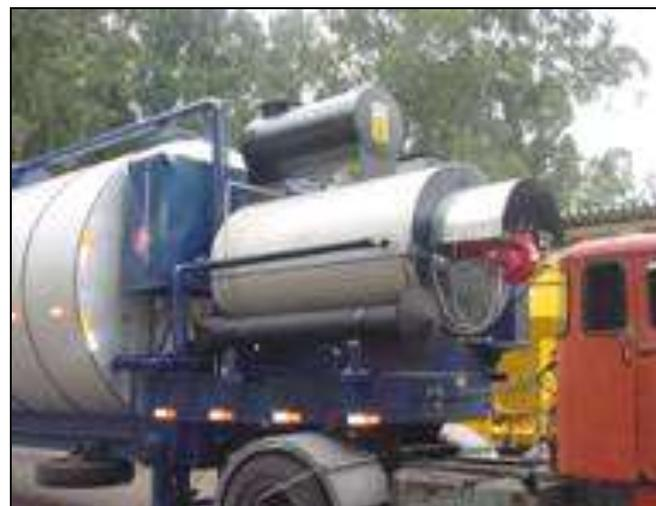
Aquecedor incorporado em sistema de tancagem móvel
