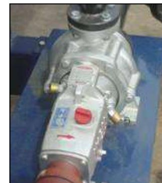
**TAMANHO:** A bomba é selecionada de acordo com a vazão de óleo necessária para garantir a potência térmica de cada aquecedor, tendo portanto tamanhos diferenciados de acordo com o modelo do aquecedor, com pressão suficiente para garantir a circulação do óleo dentro de todo o sistema (Aquecedores, redes e consumidores) térmico do usuário:
