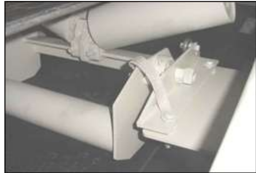
Balanza de las cintas dosificadoras Magnum 80, Magnum 140, Magnum 140A, Magnum 160 Max y E100 P
