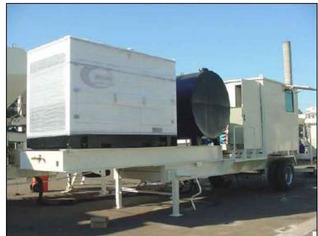
Cabina separada con generador propio
