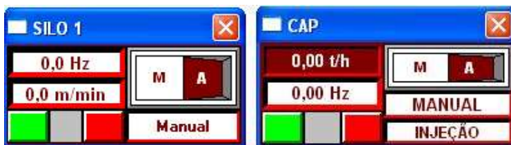
Figura 23 – Exemplo de acionamentos com inversores de frequência
