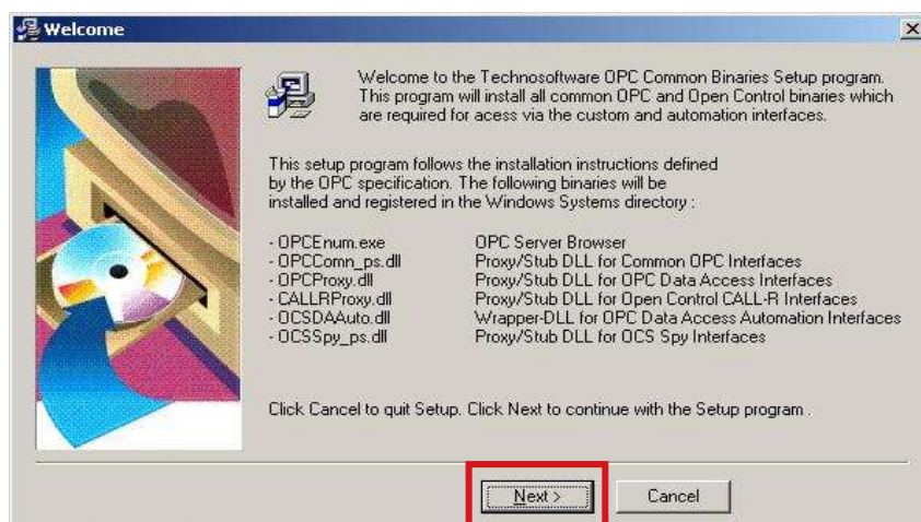
Figura 49 – Instalação do OPC Server
