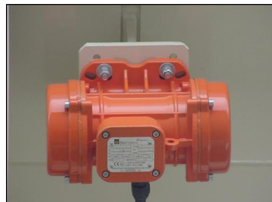
Detalhe da montagem do vibrador
