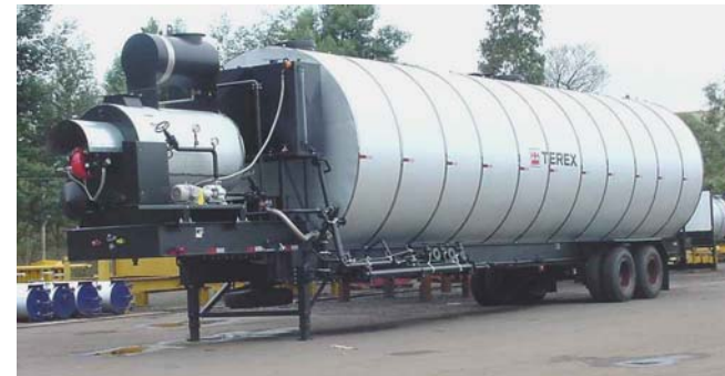
Aquecedor incorporado em sistema de tancagem móvel
