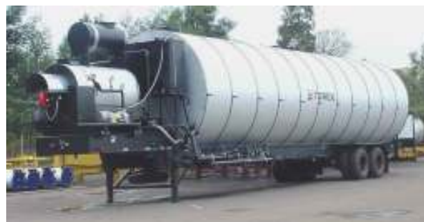
Aquecedor incorporado em sistema de tancagem móvel
