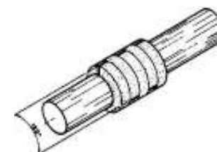
Posição dos anéis defasados em 120°
