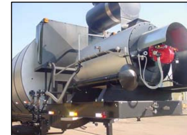
Aquecedor incorporado em sistema de tancagem móvel
