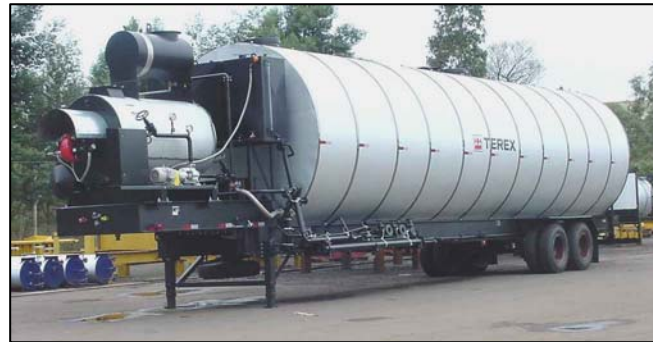
Aquecedor incorporado em sistema de tancagem móvel
