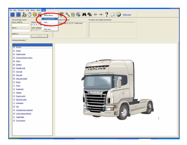
Scania Multi 1005 버전 이후부터는 사용자 설명서가 설치되어 있으며 텍스트 메뉴의 "도움말"을 통해 쉽게 액세스할 수 있습니다. 사용자 설명서는 PDF 형식이라 쉽게 인쇄할 수 있으며 Scania Multi 가 설치될 때 사용된 것과 동일한 언어로 설치되어 있습니다.
