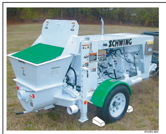
Figura 4 Colocación apropiada de estabilizadores y calzos
