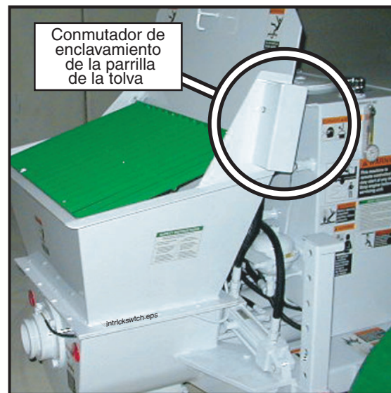
Figura 20 El conmutador de enclavamiento de la parrilla de la tolva
