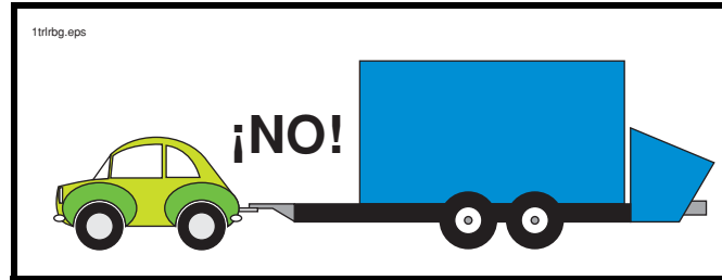
Figura 6 No remolque con un vehículo de poca potencia
