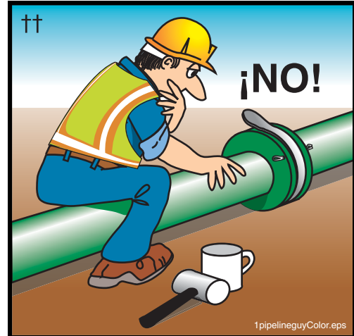
Figura 18 Nunca se ponga a horcajadas o se siente sobre una tubería presurizada
