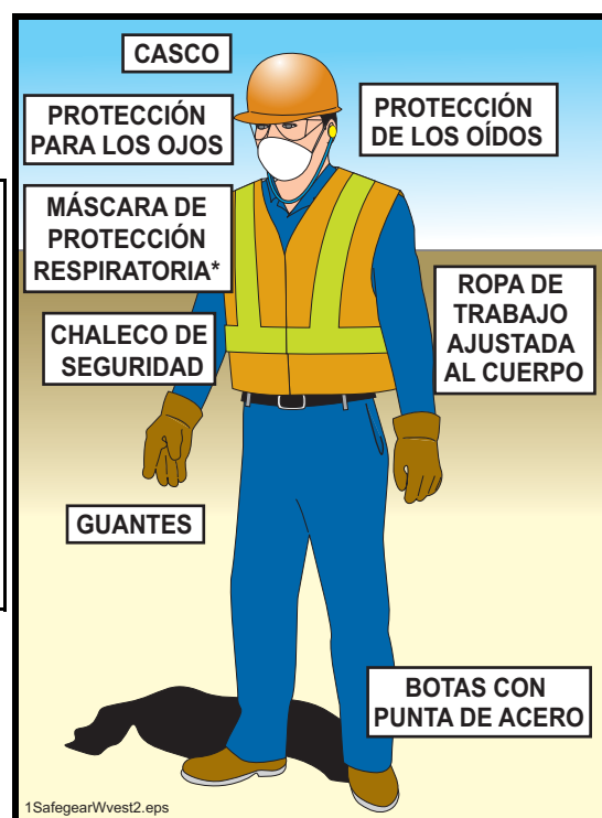
Figura 37 Use el mismo equipo personal de protección que el operario
