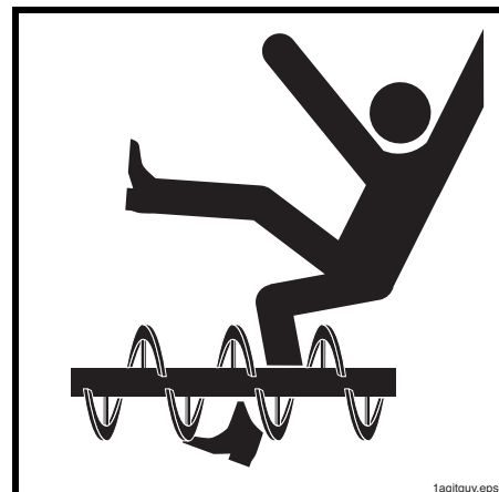
Figura 81 Levantando la rejilla de la tolva expone el agitador y la válvula de concreto
