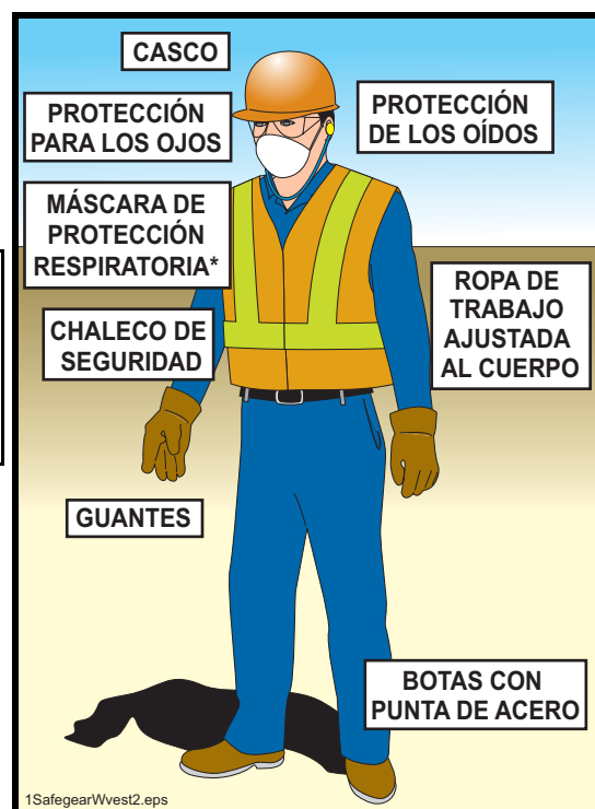
Figura 73 Use el mismo equipo personal de protección que el operario
