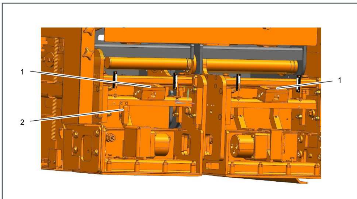
Fig. 2-13: Caja de enchufe (pieza extensible del tablón)
