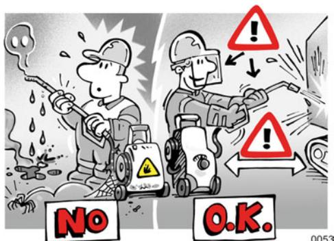
Die Verschraubungen aller Schläuche müssen dicht sein. Vor Abbau des Schlauches muss dieser drucklos gemacht werden.
