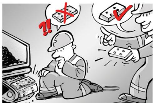
Reponga los neumáticos deteriorados o desgastados o las tejas (en caso dado) de la forma indicada en el manual de instrucciones de servicio. Tense las orugas de los mecanismos de traslación (en caso dado) según se indica en el manual de instrucciones de servicio.
