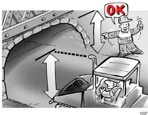
Compruebe la altura/anchura de transporte permitidas (p. ej. techo de protección contra la intemperie, escaleras, etc.).
