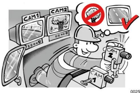
Si su máquina está equipada con un sistema de cámara / monitor, ajuste el monitor de forma que pueda detectar la imagen rápidamente y sin deslumbramiento.
