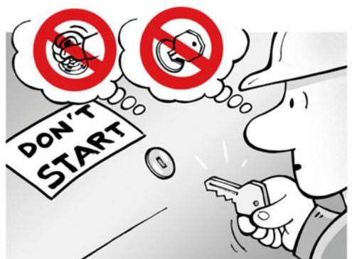
¡No arranque el motor ni accione ningún elemento de manejo si en ellos se encuentra un letrero que prohíba categóricamente el accionarlos!
