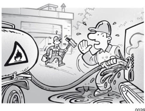
¡La máquina tiene que estar en un suelo, en el que se pueda reconocer y eliminar el combustible derramado!
