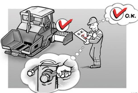
Плита и уширители могут осесть и повредиться. На плите перемещать уширитель только при затянутых винтах.
