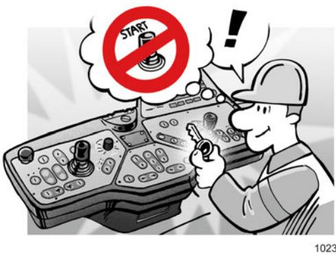
Nakon pretovara stroja isključite motor!
