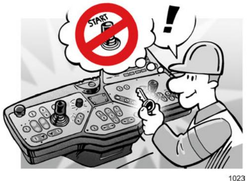
Isključite pogonski motor prije napuštanja mesta vozača/upravljačkog mesta i osigurajte stroj od nemamjernog pomicanja i neovlaštenog korištenja!
