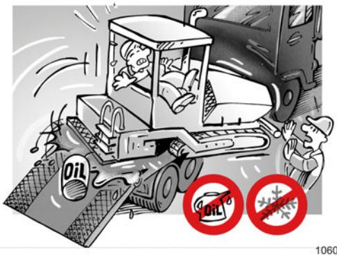
Pazite da na utovarnim rampama nema nečistoća (poput ulja, snijega, leda itd.)!
