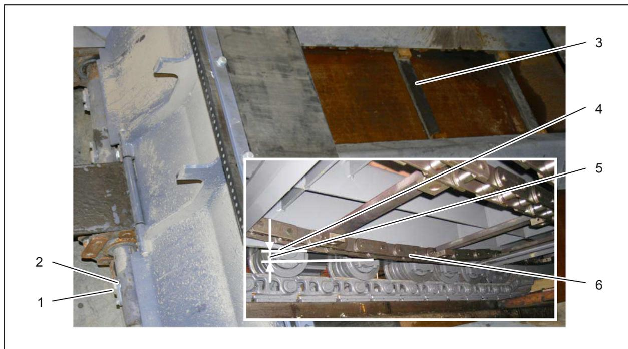
Fig. 4-29 : Vérifier la tension des bandes à racleurs
