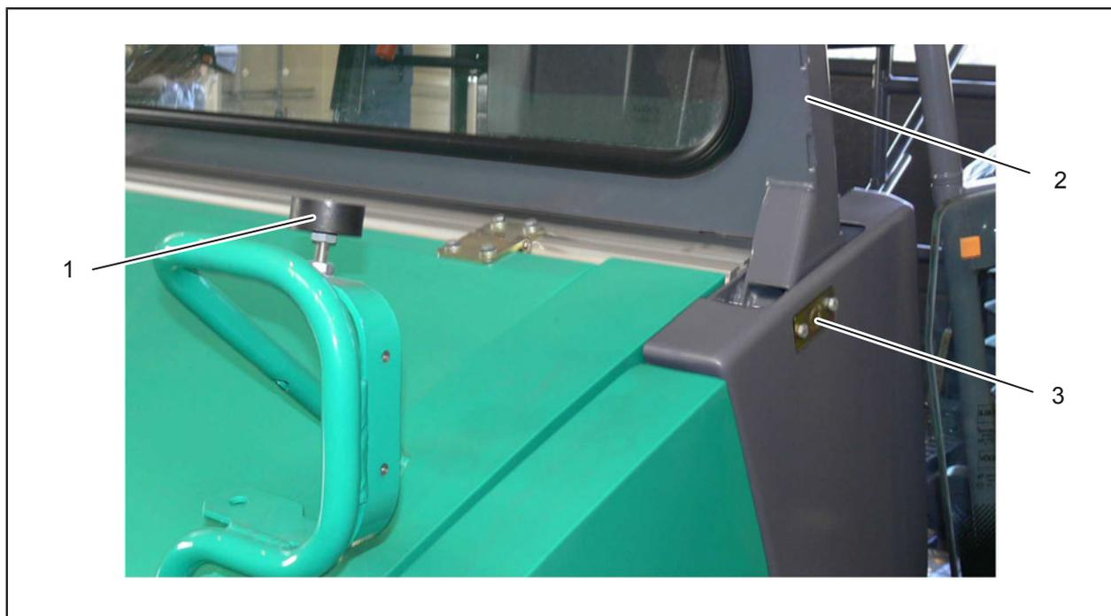
Fig. 6-5 : Montage du cadre de pare-brise
