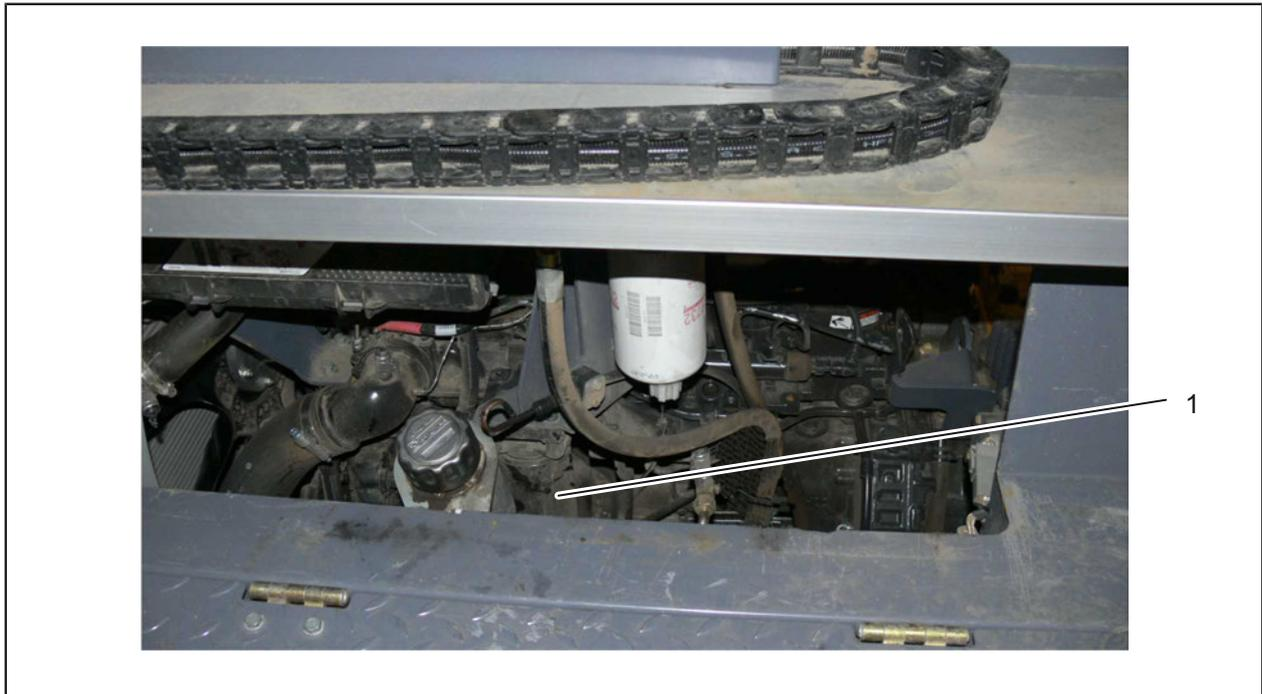
Fig. 4-10 : Filtre à carburant
