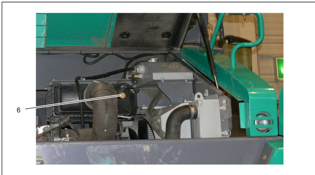
Fig. 4-13 : Capteur de dépression
