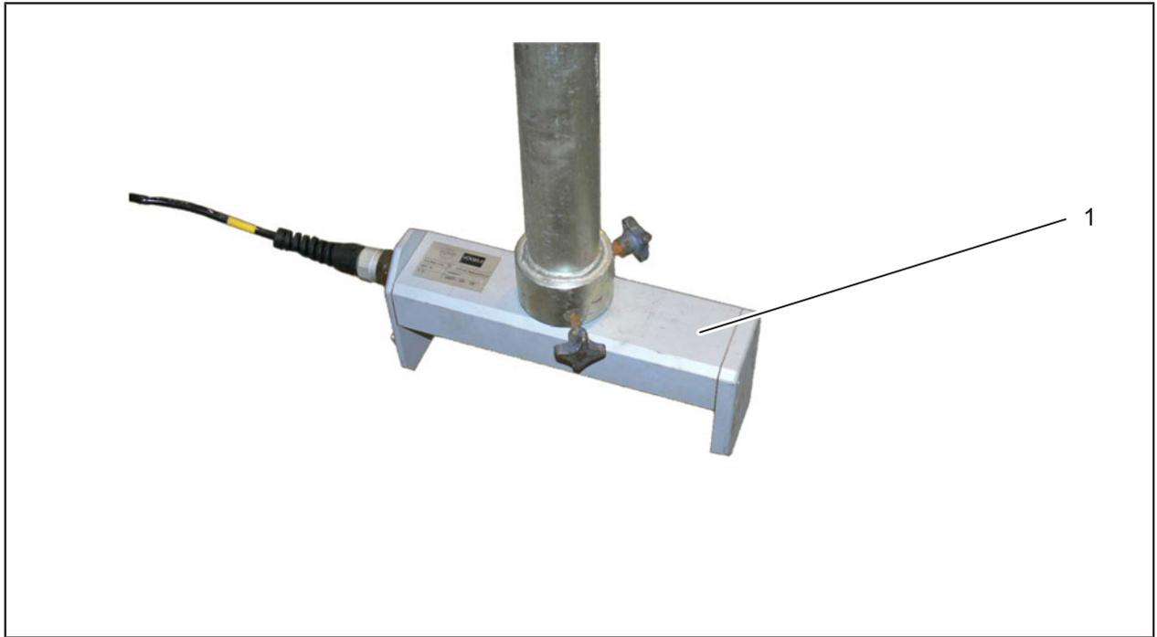
*Fig. 2-112 : Capteur à longue portée à ultrasons*
