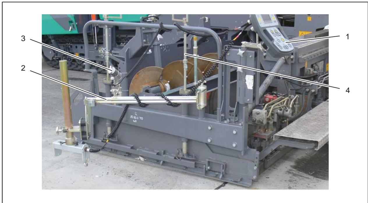
Fig. 2-110 : Système de nivellement NIVELTRONIC Plus®
