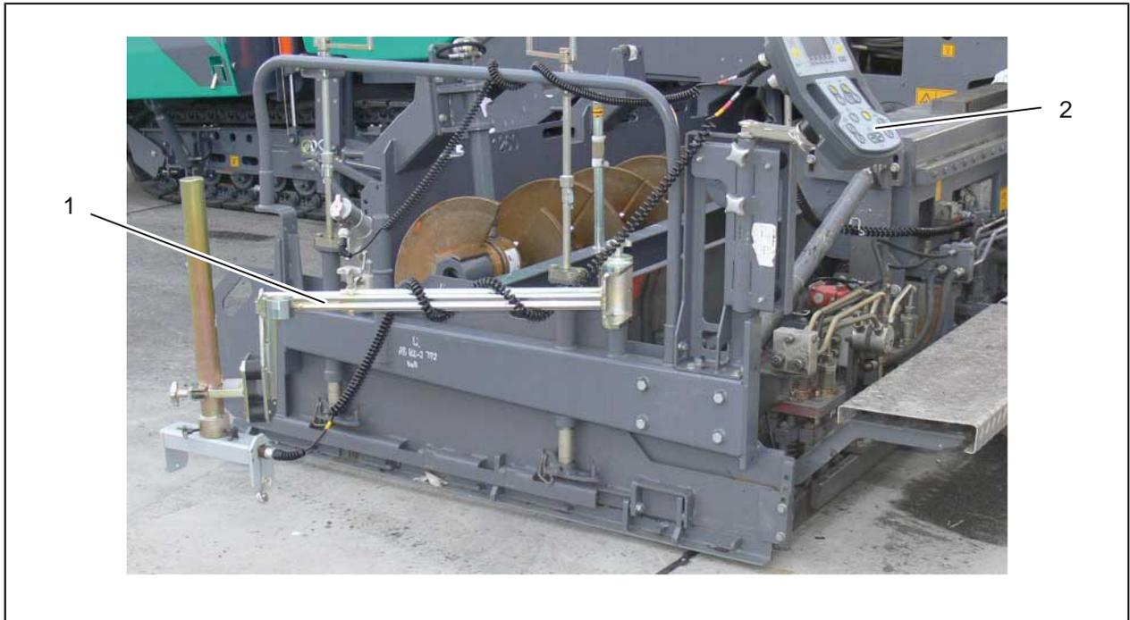
Fig. 6-26 : Système de nivellement NIVELTRONIC Plus®
