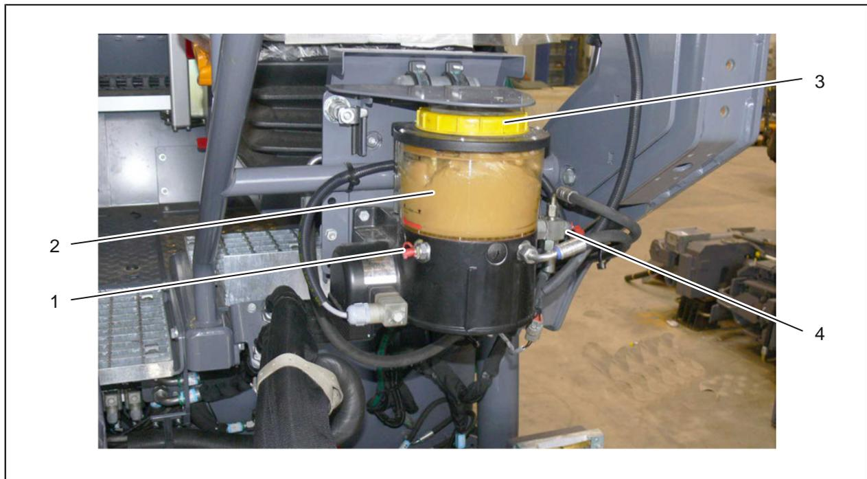
Fig. 4-38 : Installation de lubrification centrale
