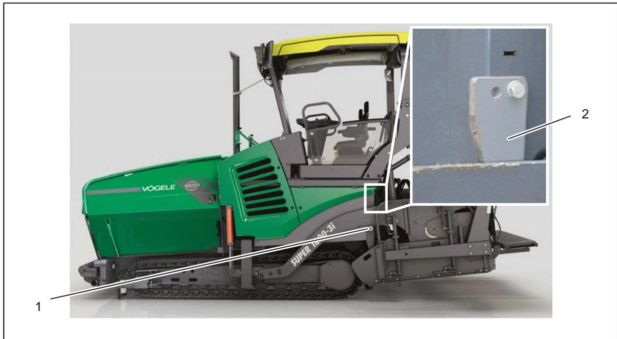
Fig. 2-123 : Verrouillage de table
