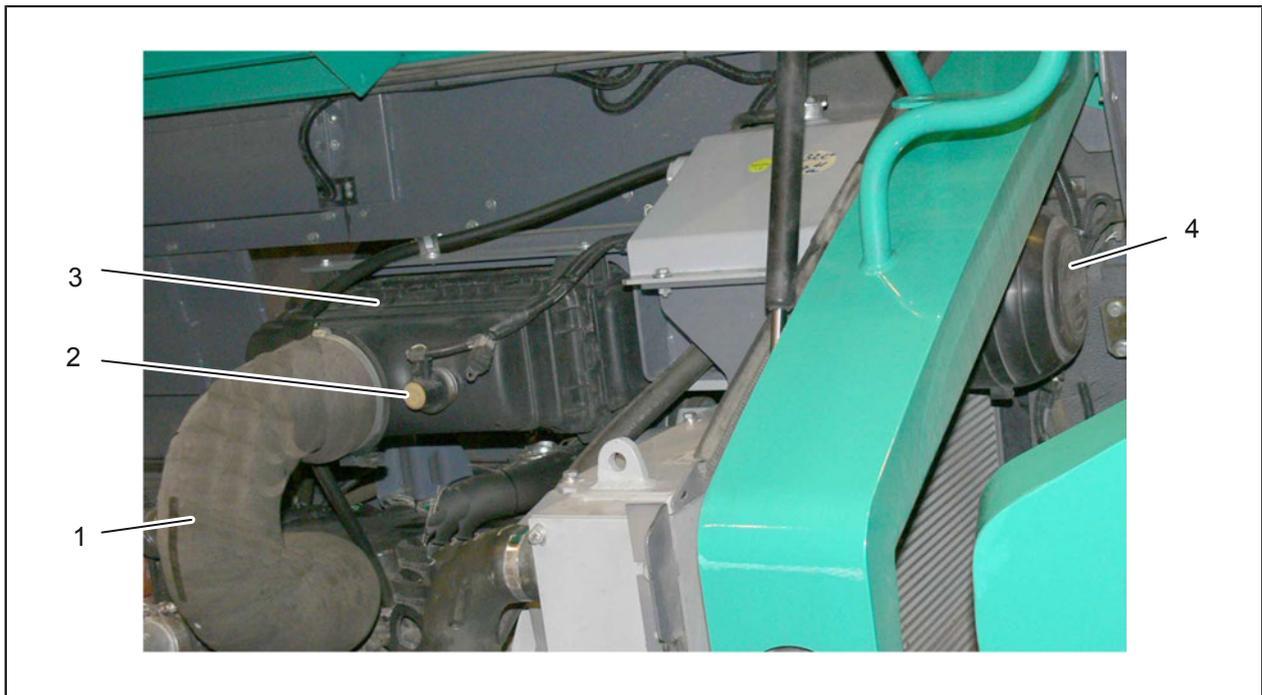
*Fig. 2-77 : Air de combustion / aspiration d'air*
