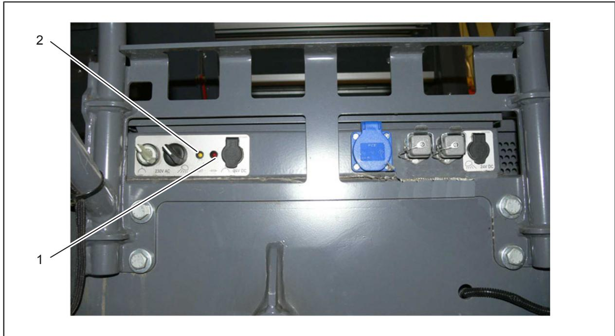
Fig. 2-96 : Boîtier électrique de chauffage externe
