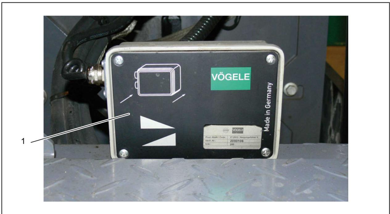
*Fig. 2-115 : Capteur d'inclinaison***[1] Capteur d'inclinaison**
