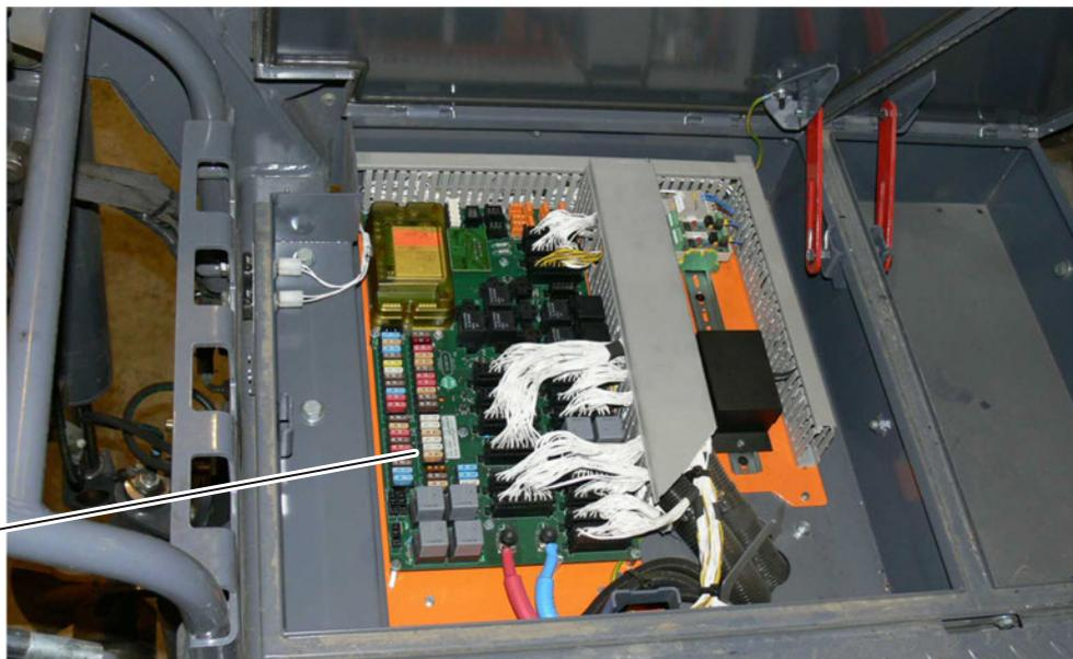
Fig. 2-95 : Boîtier électrique 24 V
