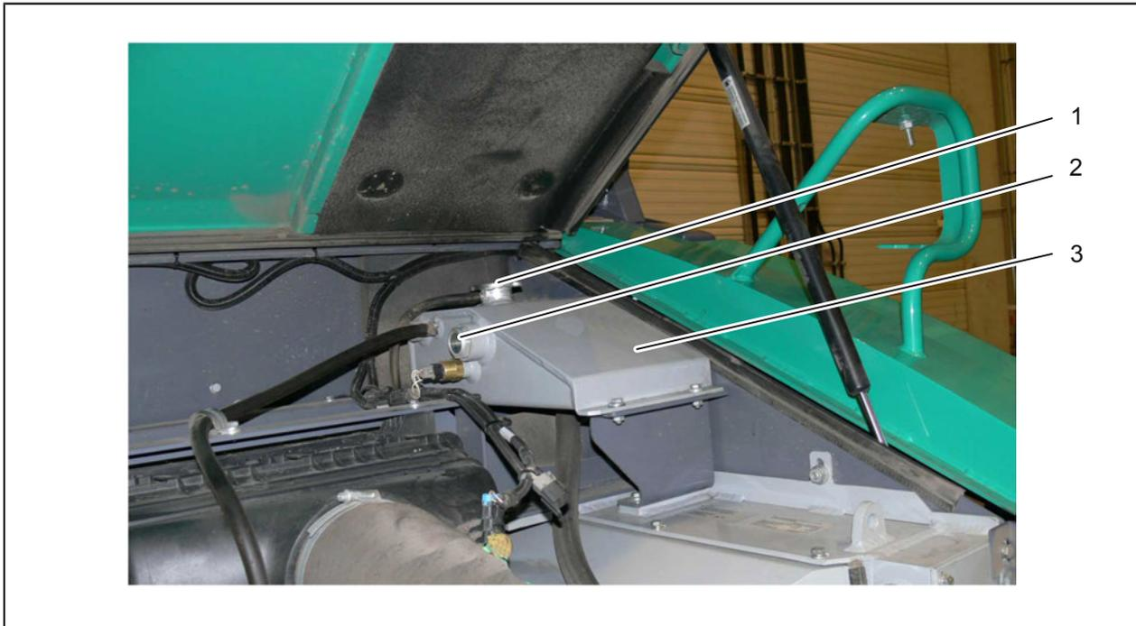
Fig. 4-15 : Contrôler le réfrigérant et faire l'appoint
