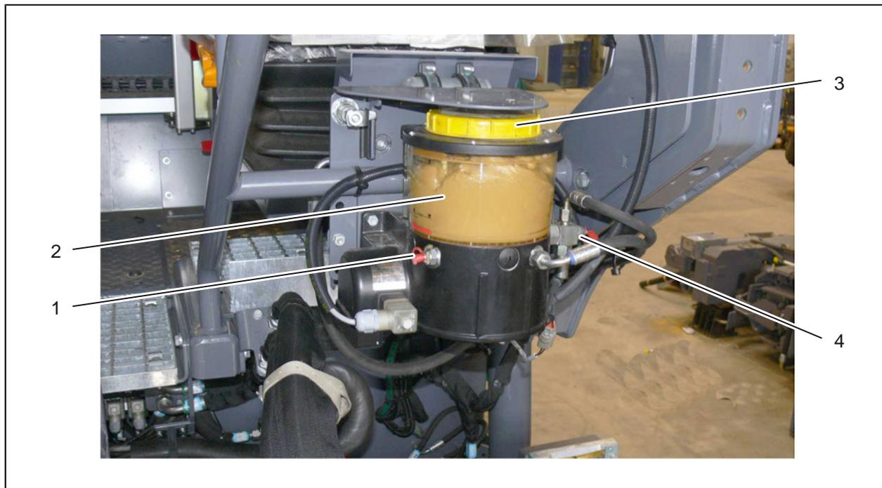
Fig. 2-127 : Installation de lubrification centrale
