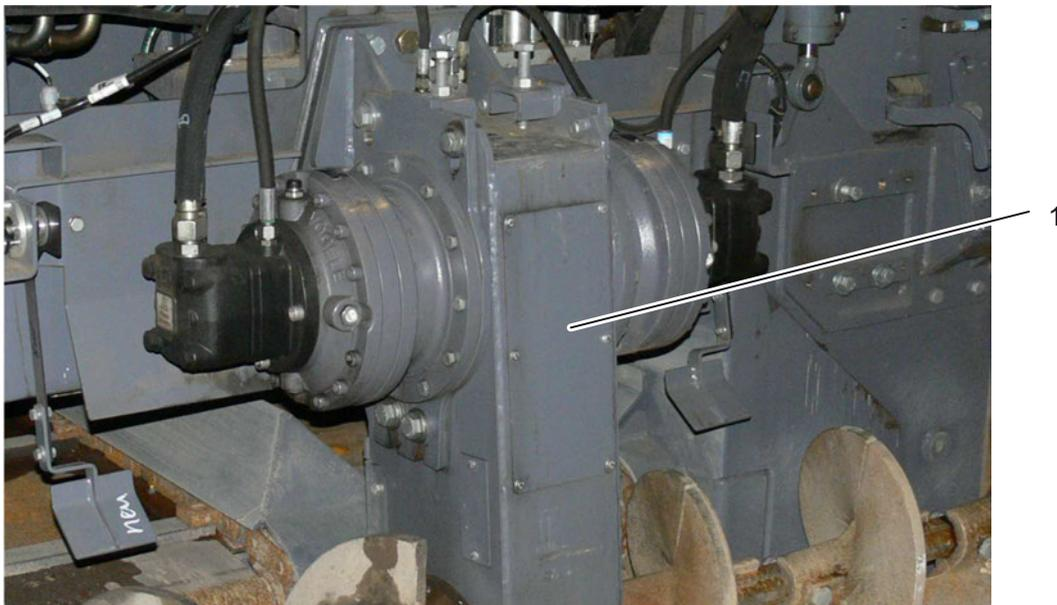
Fig. 4-33 : Unité d'entraînement des vis sans fin de distribution
