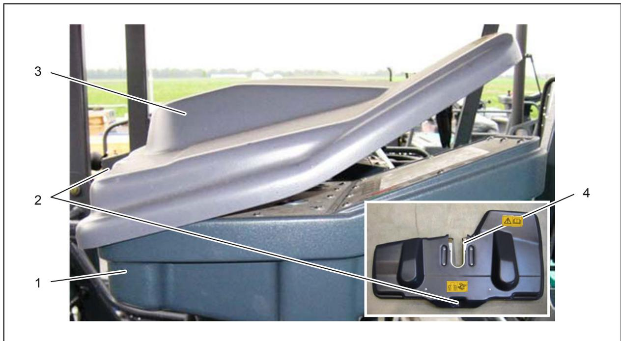
Fig. 3-10 : Monter la protection anti-vandalisme
