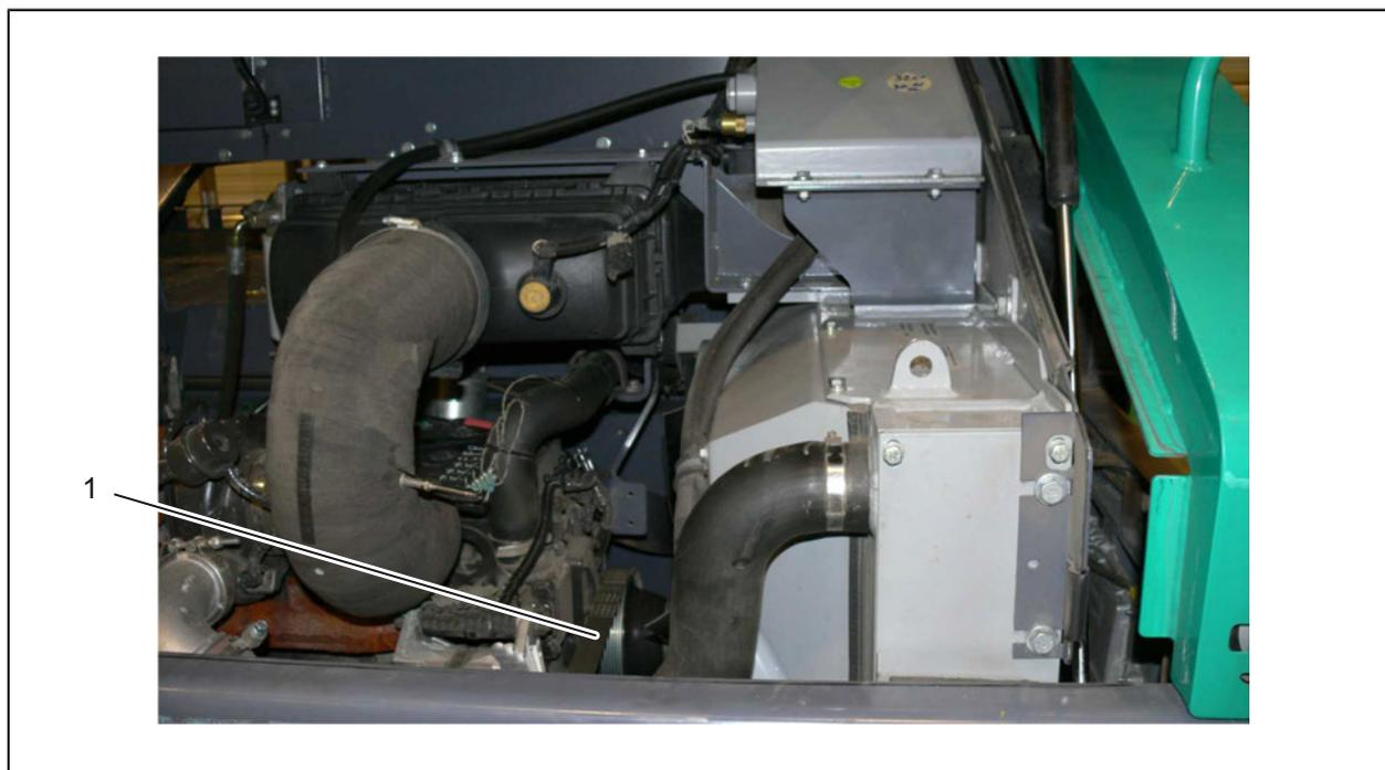
Fig. 4-7 : Contrôler la bande de force
