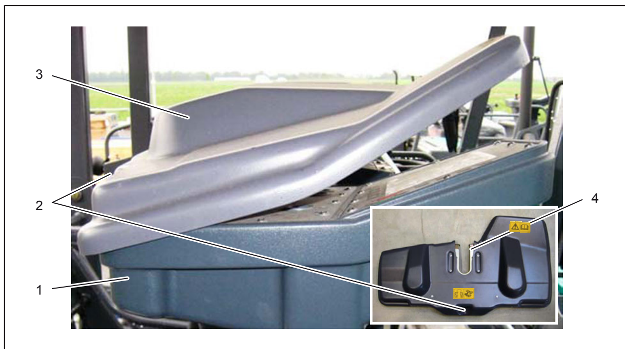
Ábra 3-10: A rongálásvédelem felszerelése
