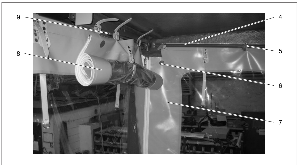
Ábra 6-9: A védőponyva felszerelése (II)
