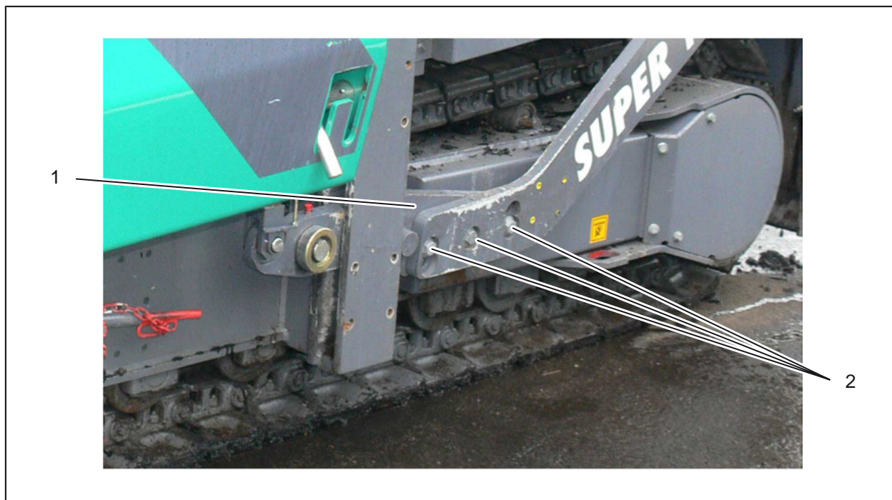
Sl. 6-34: Nastavitev nivelirnih prečnikov
