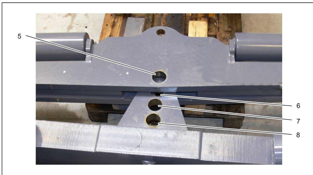
Sl. 6-14: Premaknjen pritisni prečnik
