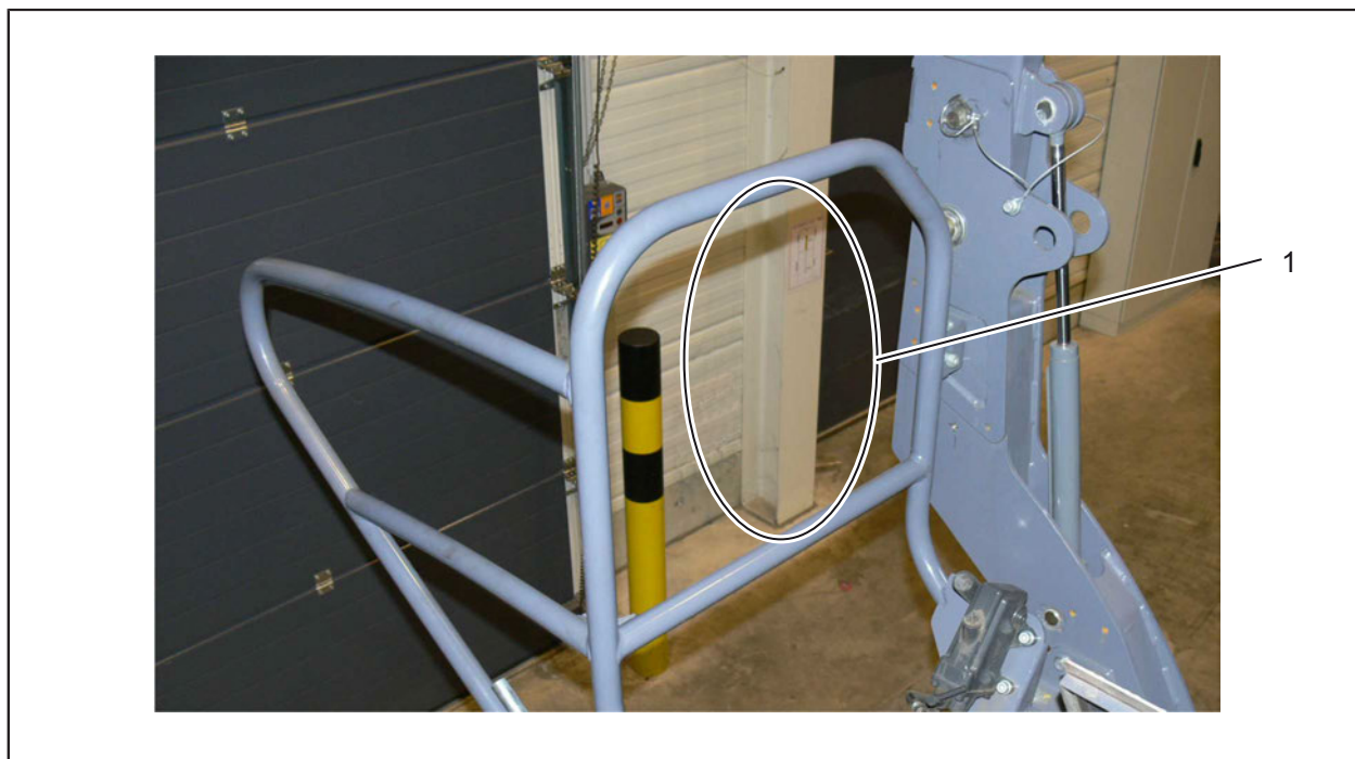
Sl. 2-11: Prostor za gasilni aparat
