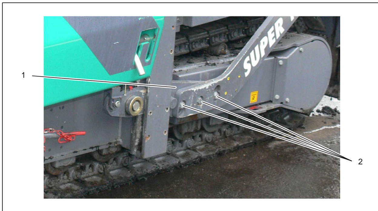
Att. 6-34: Nivelēšanas lonžerona regulēšana
