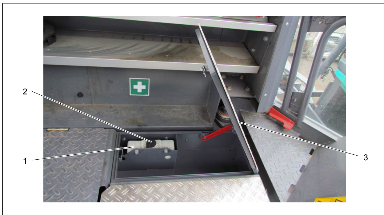
Att. 2-70: Logu mazgājamā šķidruma tvertne
