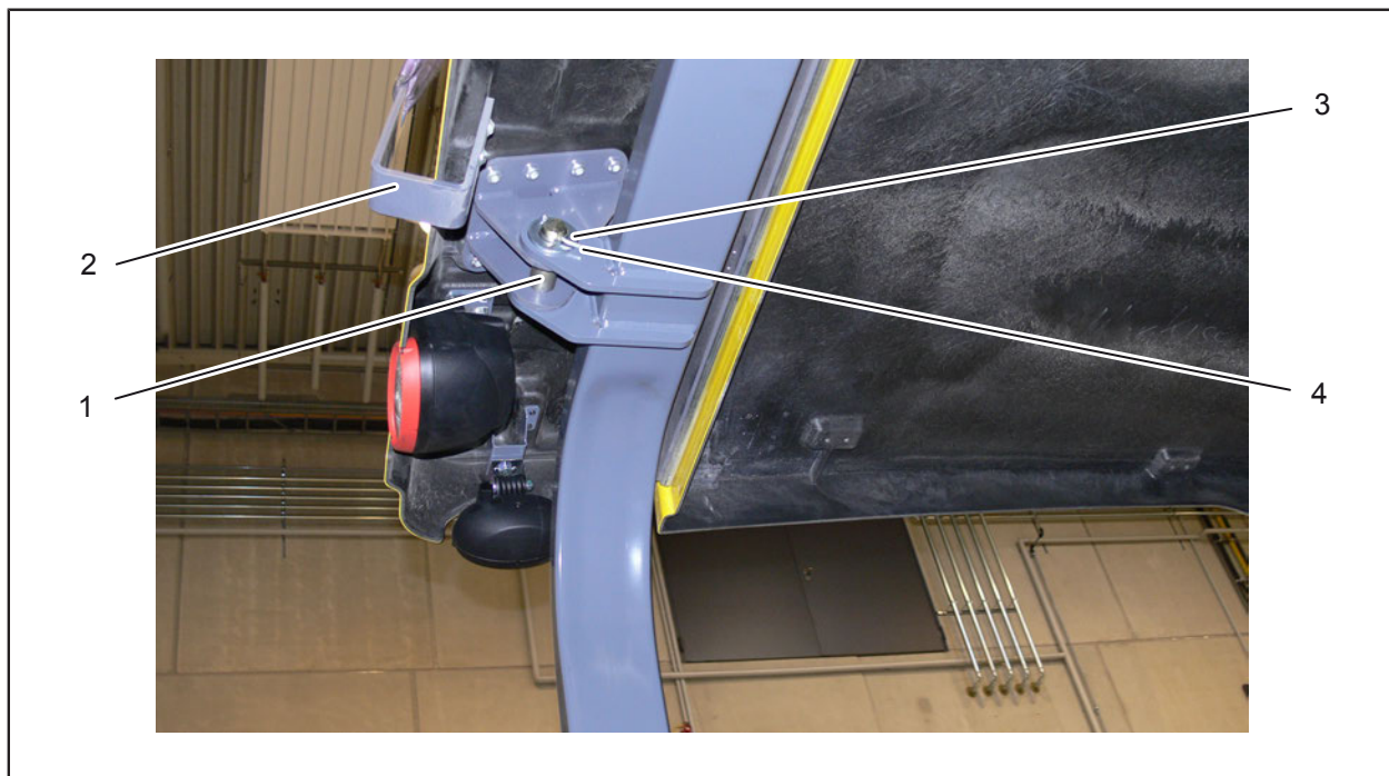
Att. 6-6: Aizsargjumta montāža
