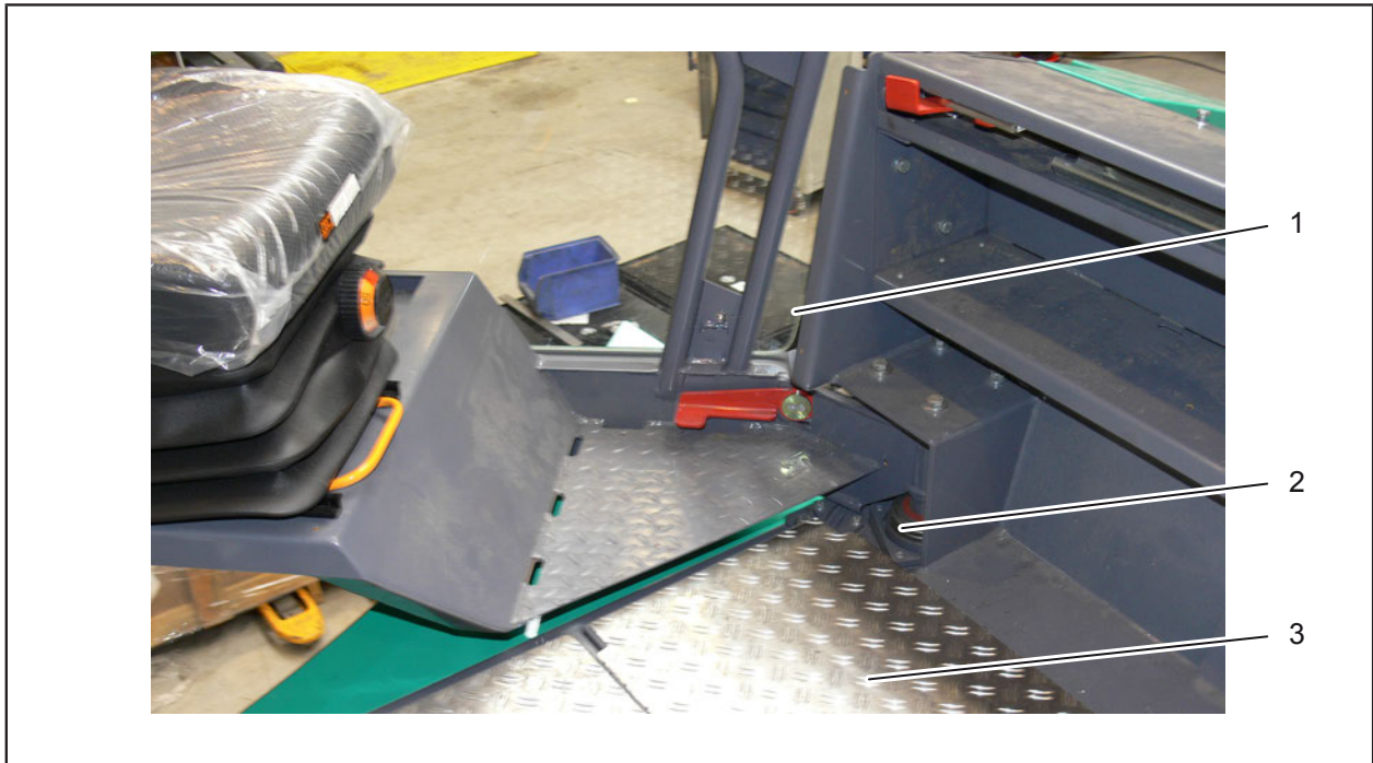
Att. 4-1: Grozāms balsts pie mašīnas vadības platformas
