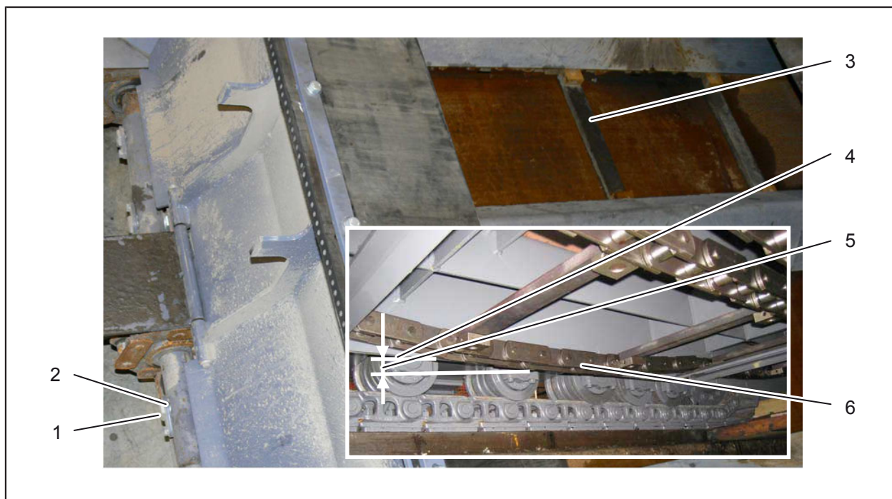
Att. 4-29: Skrāpju transportieru spriegojuma pārbaude
