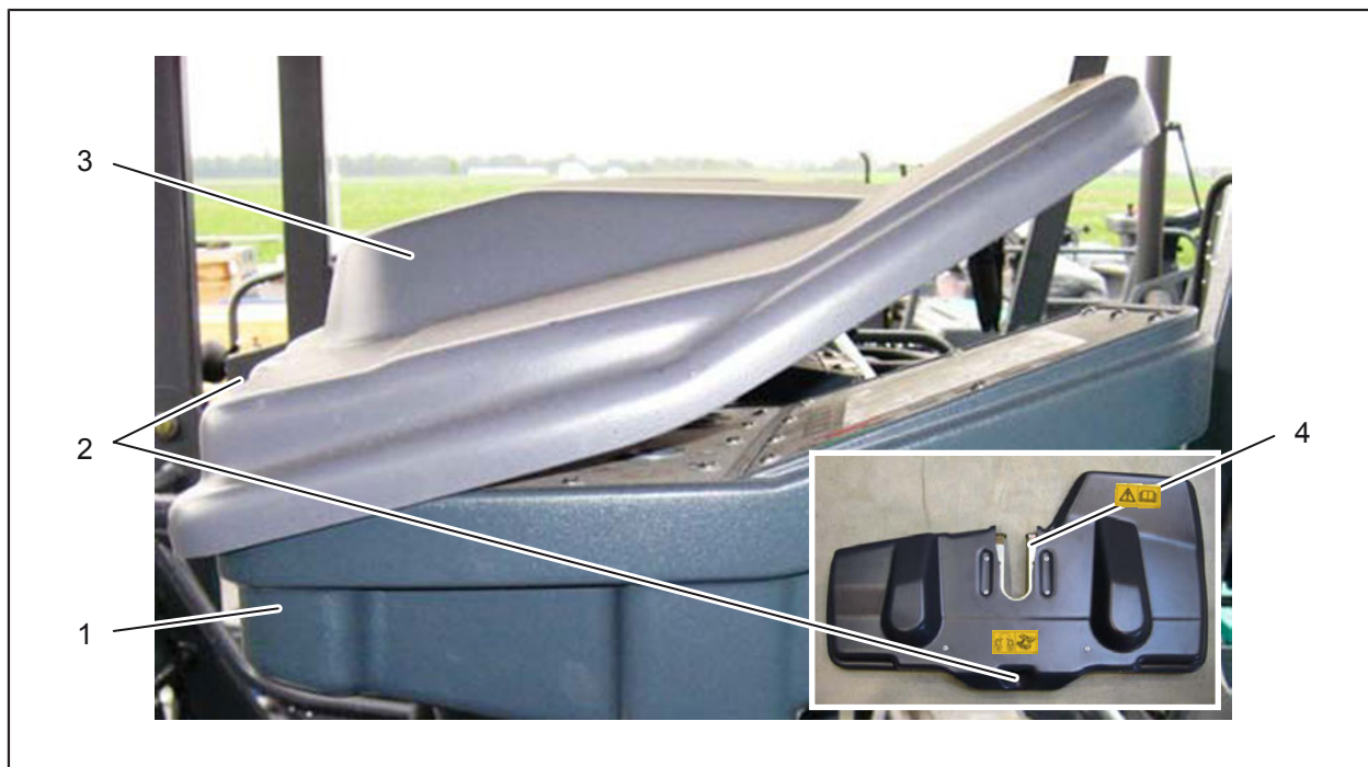
Pav. 3-10: Apsaugos nuo vandalų montavimas
