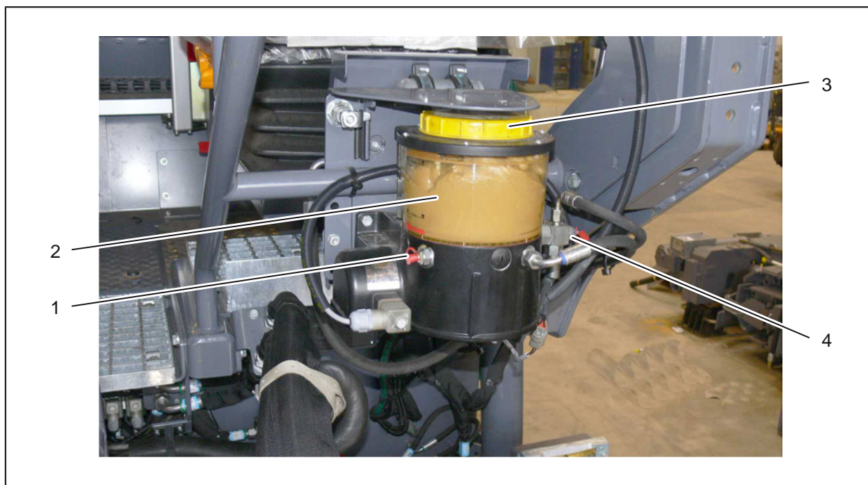
Pav. 4-38: Centrinė tepimo sistema
