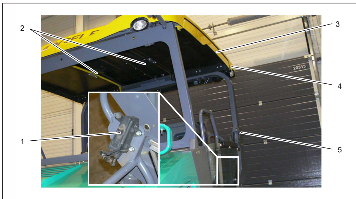
Fig. 2-69: Pavilion de protecție
