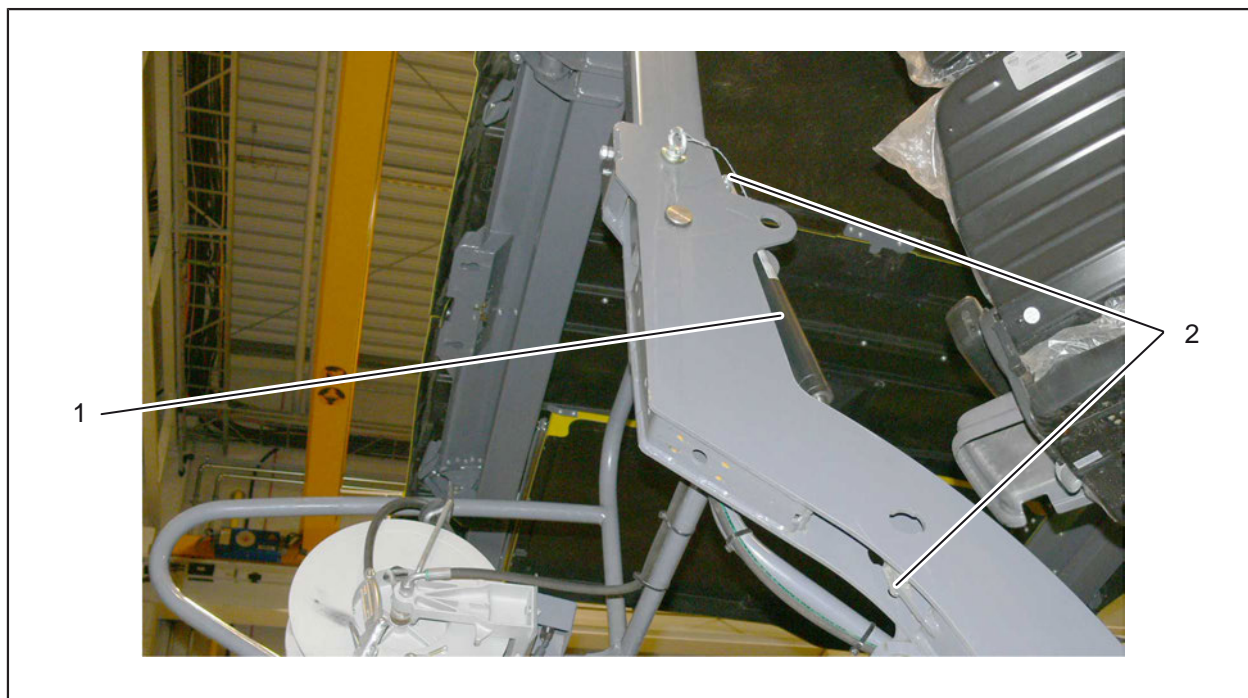
Fig. 6-4: Montarea arcului pe caz
