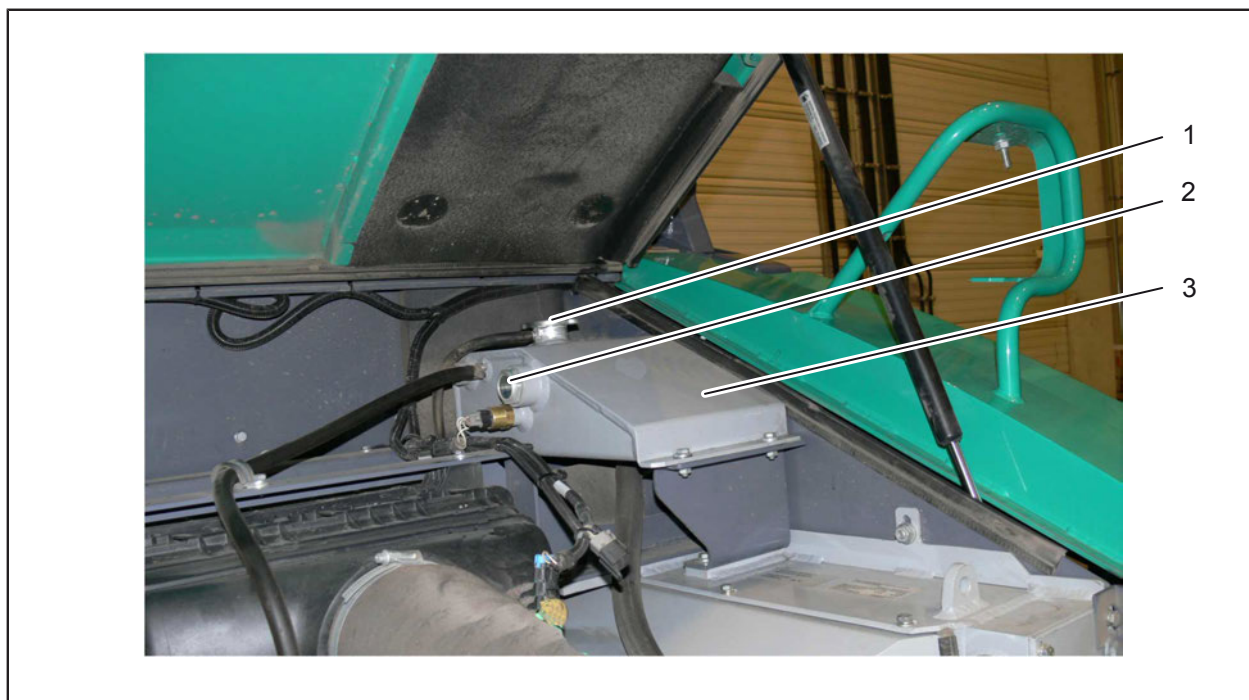
Fig. 4-15: Verificați și completați nivelul lichidului de răcire.
