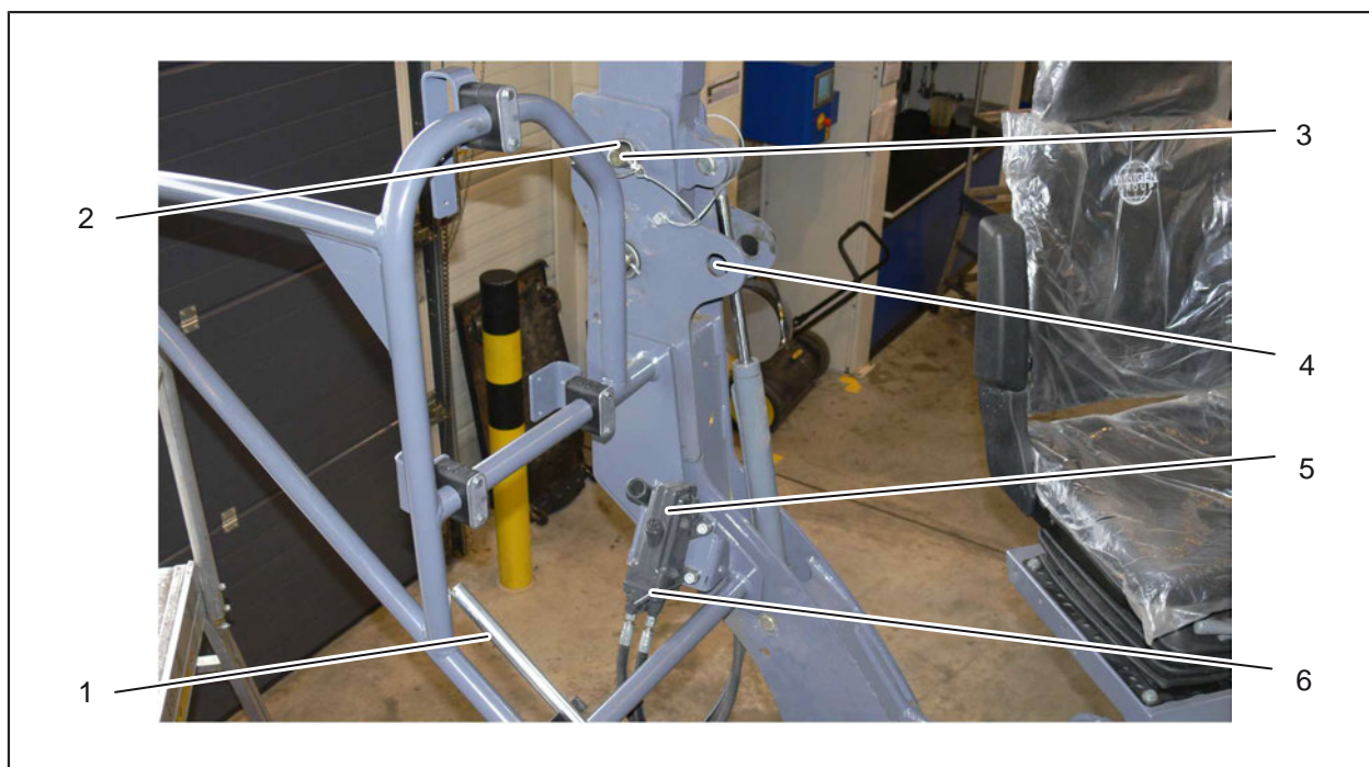
Fig. 3-14: Rabatarea pavilionului de protecție
