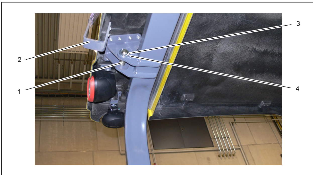
Fig. 6-6: Montarea pavilionului de protecție
