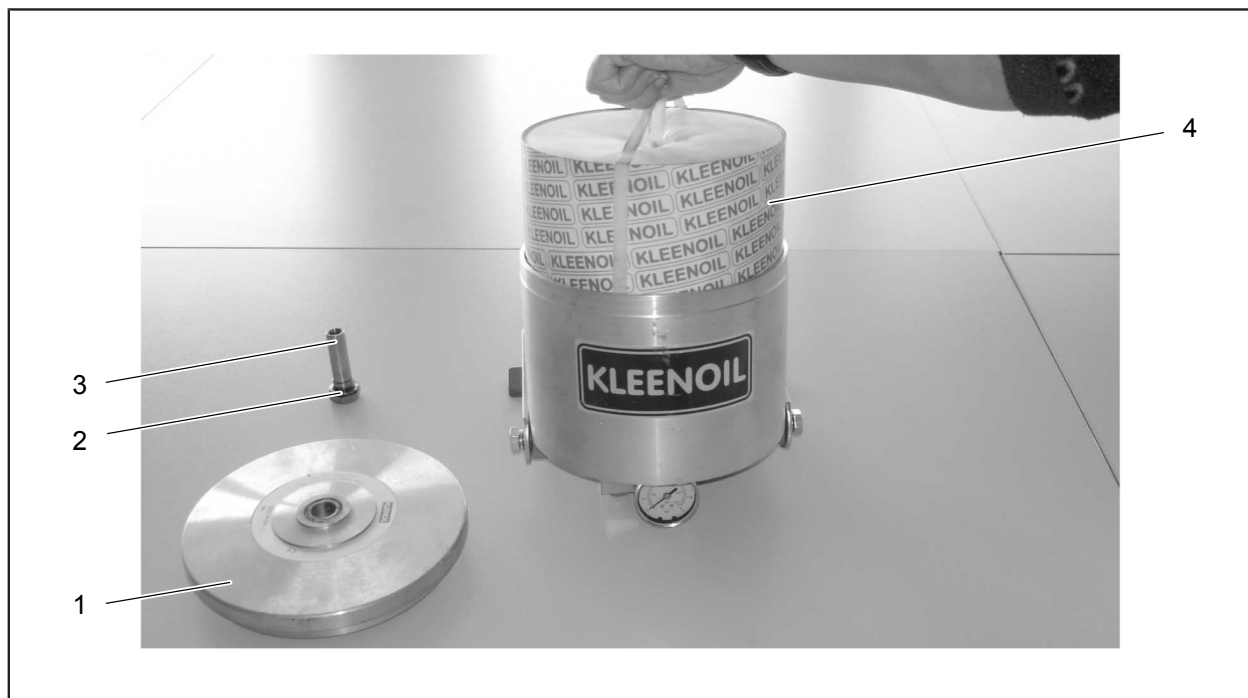
Fig. 4-24: Filtrul din circuitul secundar pentru biocombustibil
