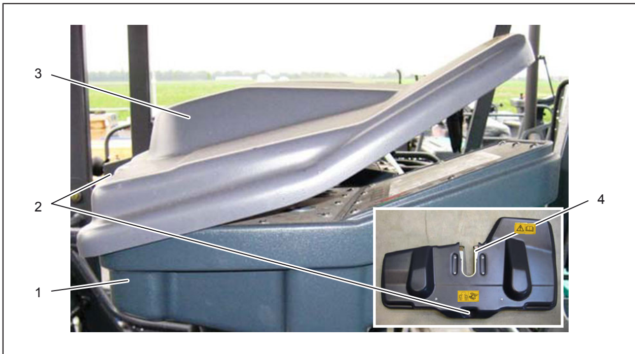
Fig. 3-10: Montarea protecției contra actelor de vandalism
