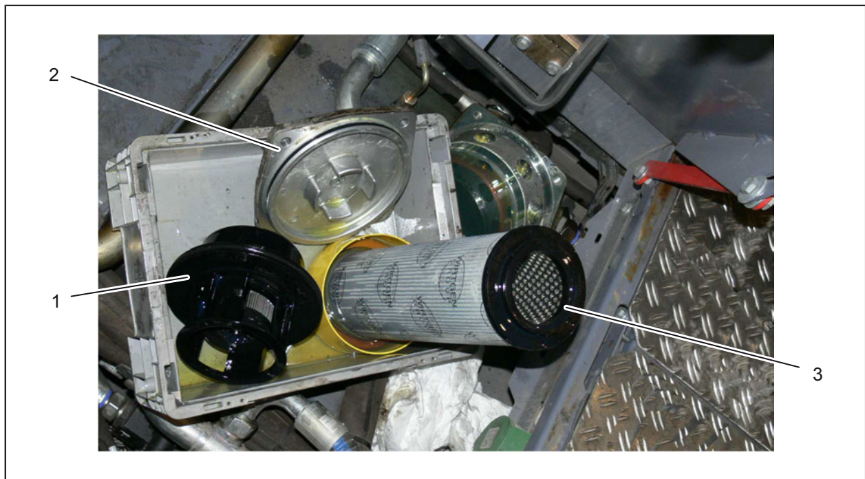
Fig. 4-20: Filtrul de aspirație din circuitul de refulare
