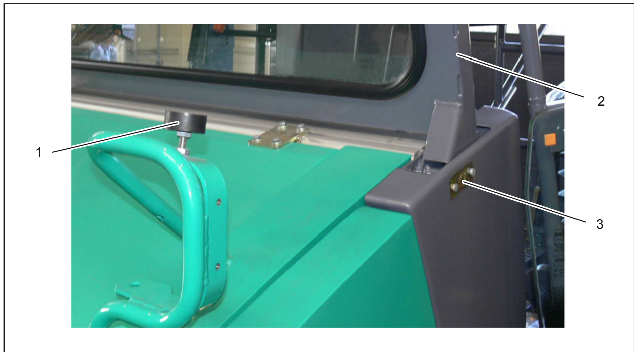
Fig. 6-5: Montarea cadrului parbrizului frontal
