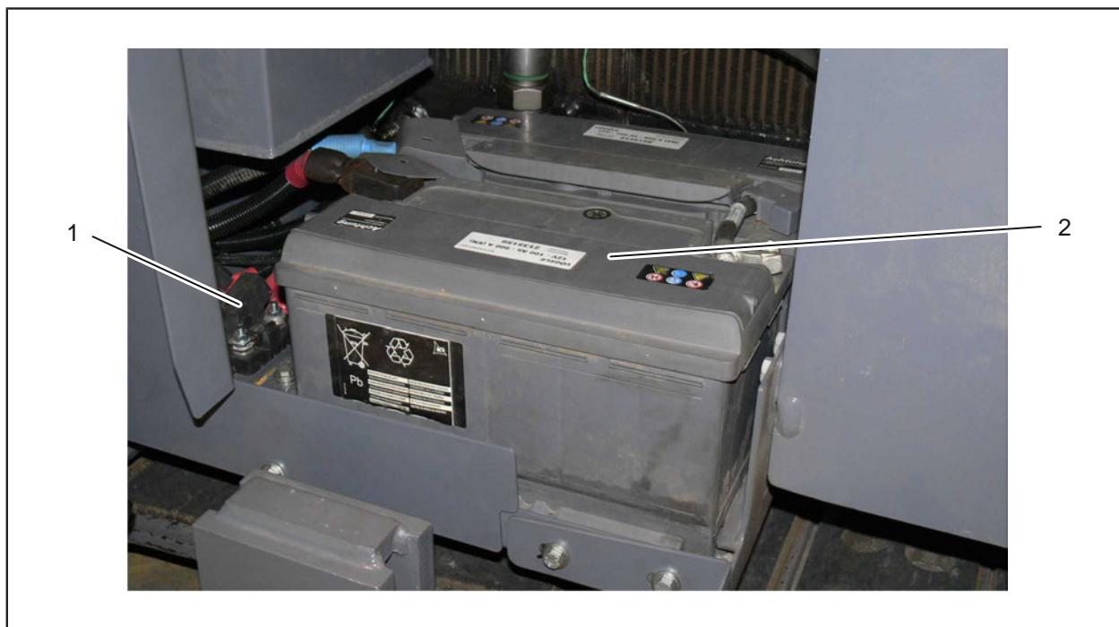
Fig. 2-91: Alimentarea electrică cu tensiune de 24 V
