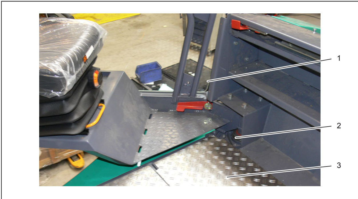
Fig. 4-1: Lagărul pivotant la postul de comandă
