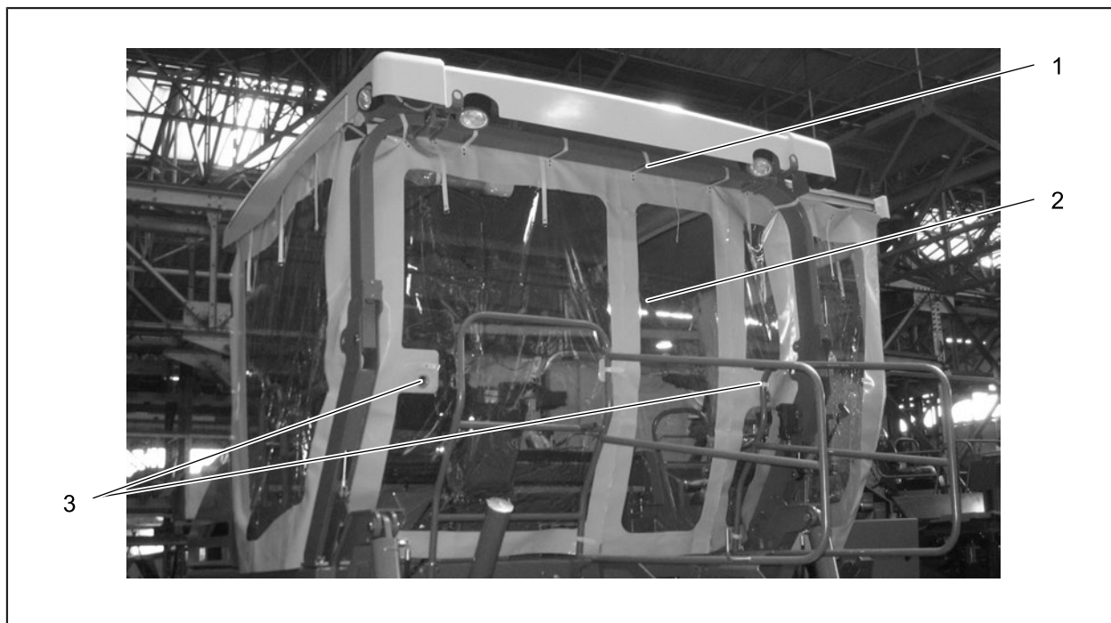
Fig. 6-8: Montarea prelatei de protecție (I)
