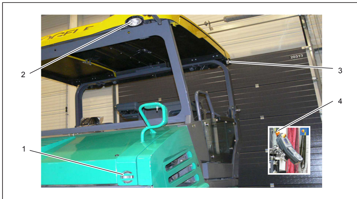
Fig. 2-5: Sistemul de iluminare și dispozitive de avertizare
