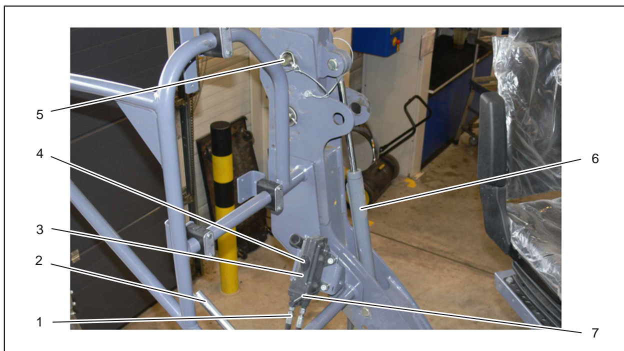
Fig. 6-3: Montarea pompei manuale
