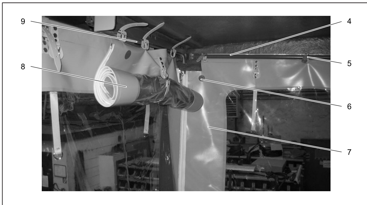
Fig. 6-9: Montarea prelatei de protecție (II)
