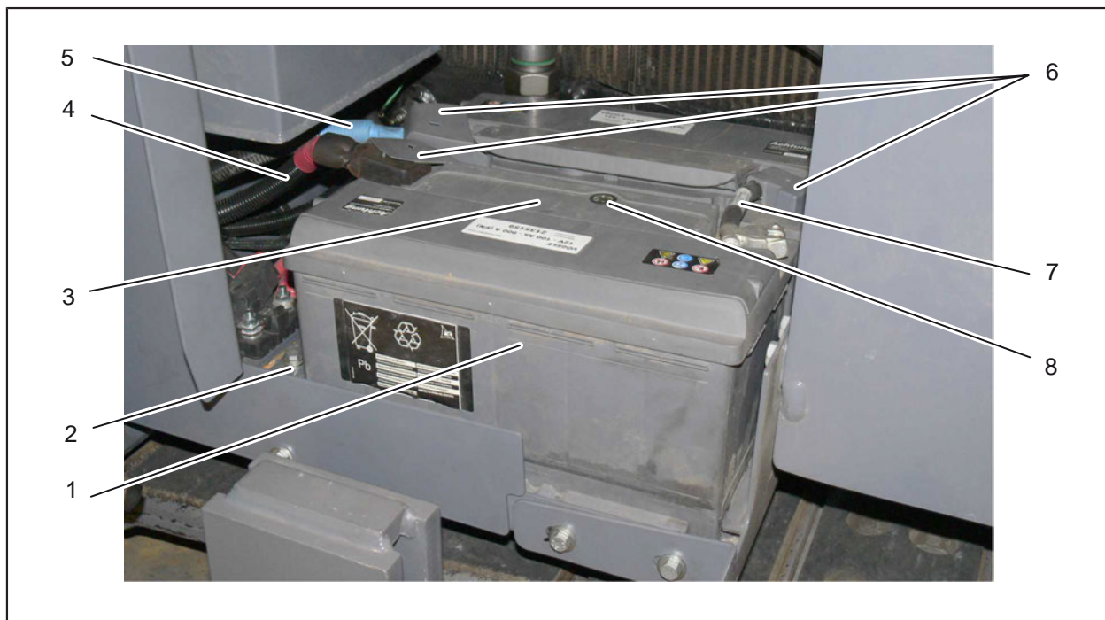
Fig. 4-25: Alimentarea electrică cu tensiune de 24 V
