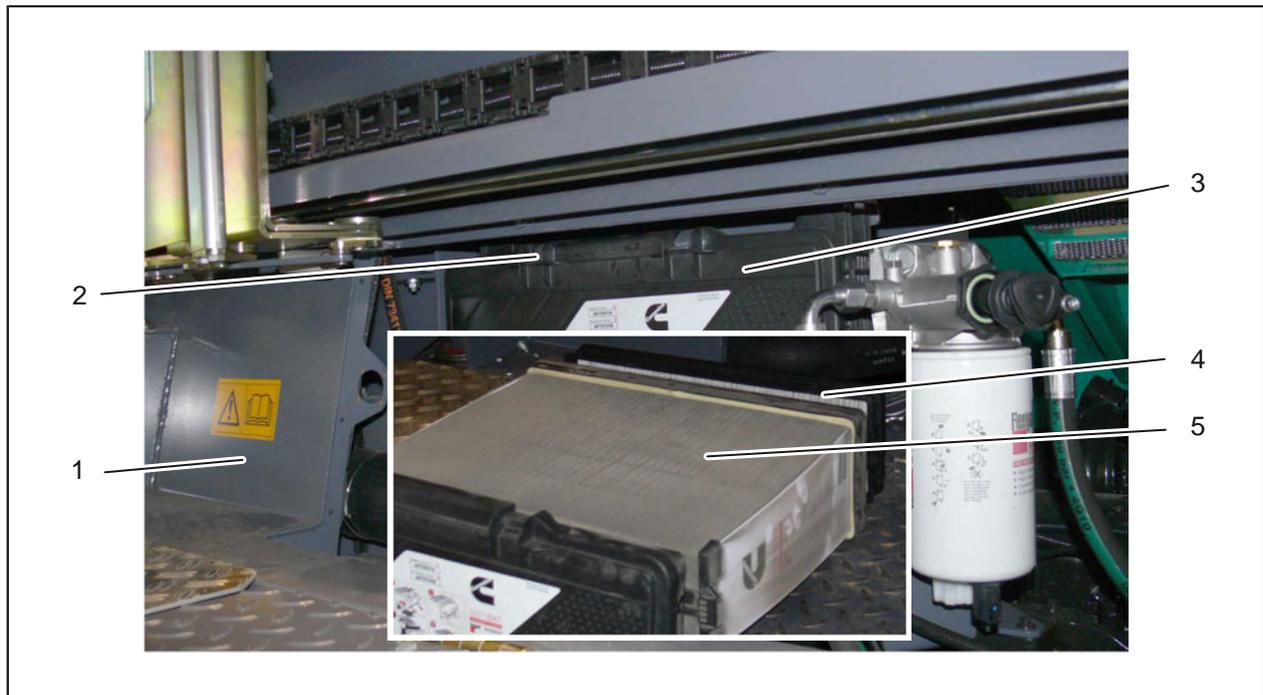
Рис. 4-12: Корпус воздушного фильтра
