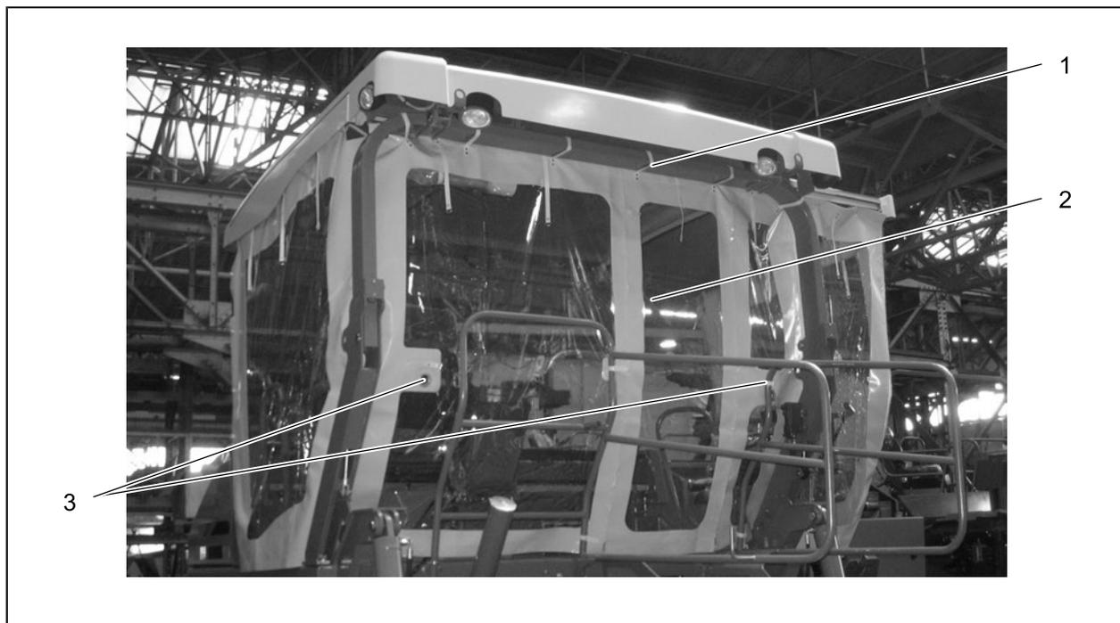
Рис. 6-8: Установка защитного тента (I)
