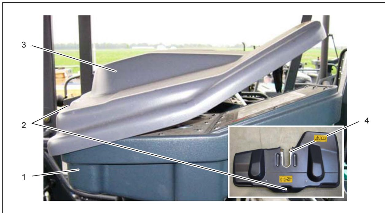
Рис. 3-10: Установка кожуха защиты от вандализма
