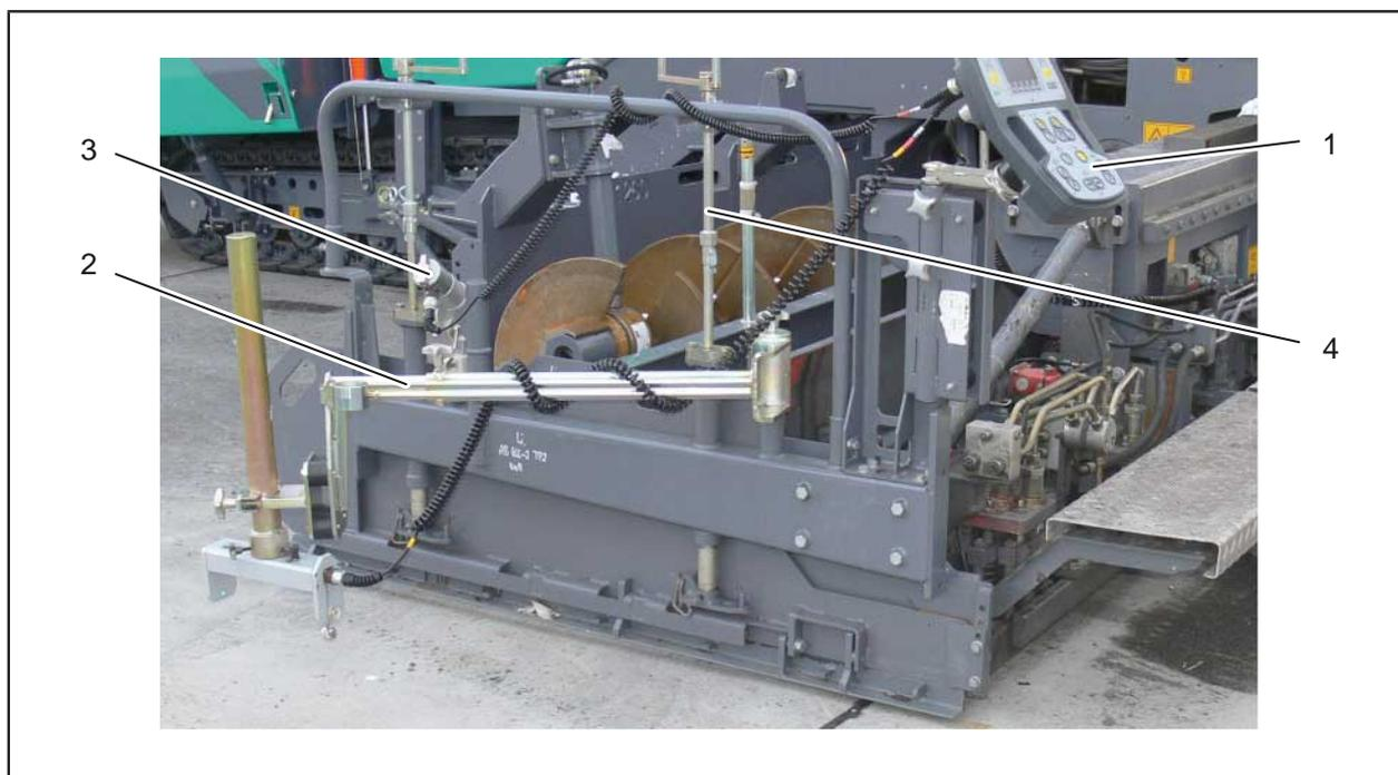
Рис. 2-110: Нивелировочное устройство NIVELTRONIC Plus®
