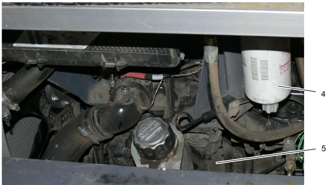
Рис. 2-75: Фильтры подачи топлива
