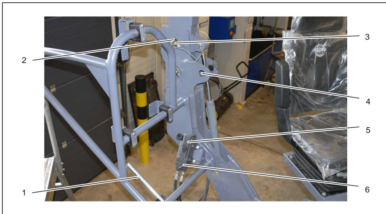
Рис. 3-3: Раскладывание защитной крыши
