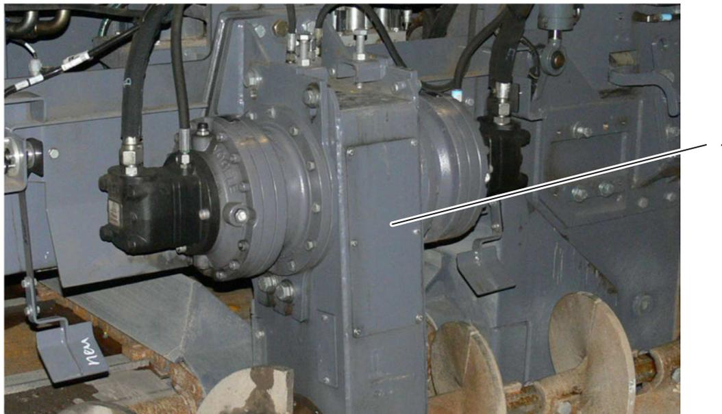
Рис. 4-33: Приводной узел распределительных шнеков
