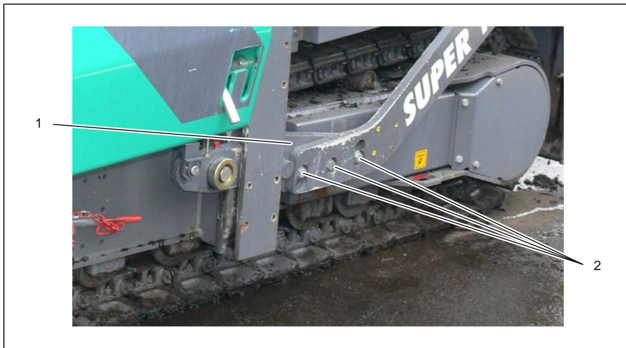
Рис. 6-34: Перемещение нивелировочного рычага
