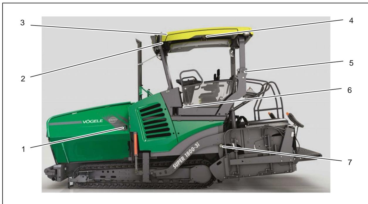
Рис. 2-10: Защитные устройства асфальтоукладчика
