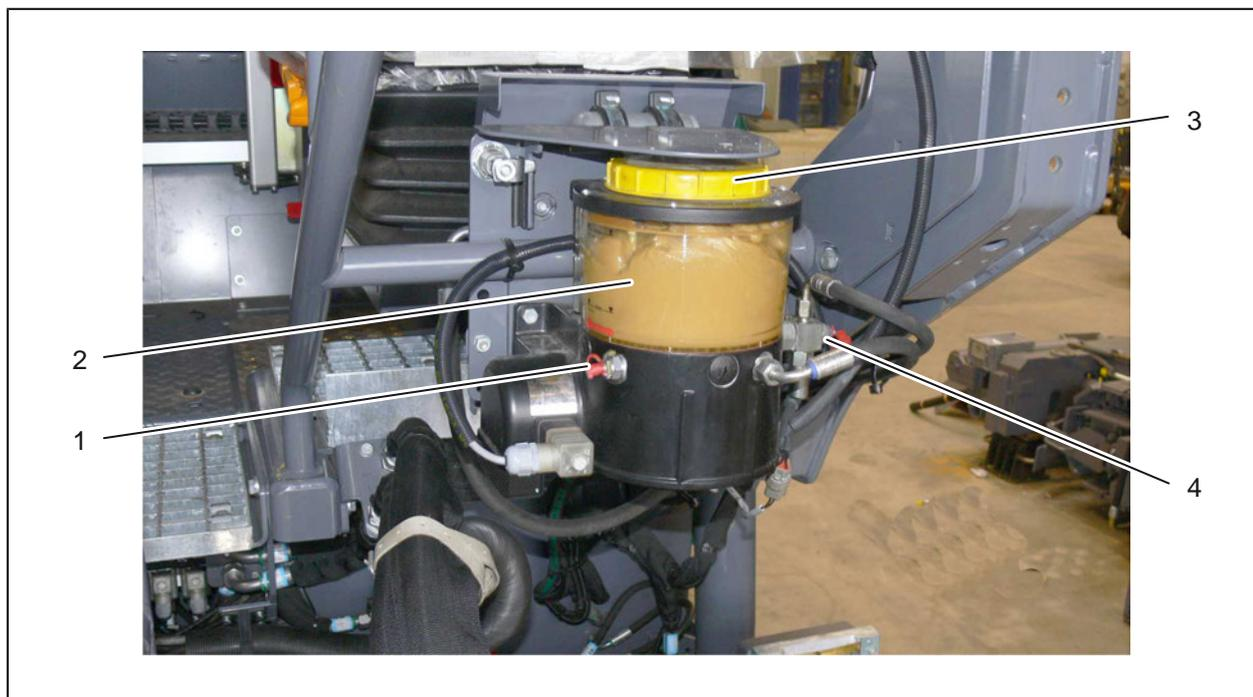
Рис. 4-38: Центральная смазочная установка
