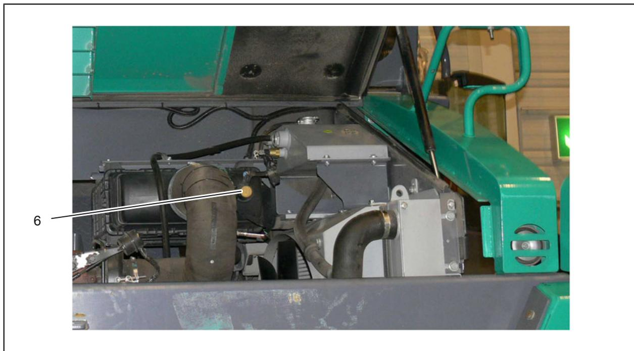
Рис. 4-13: Датчик разрежения
