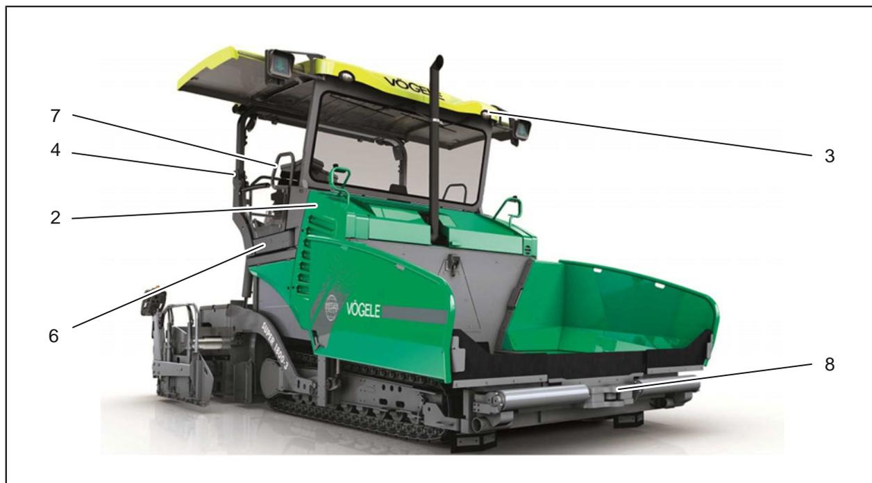
Рис. 2-1: Защитные устройства асфальтоукладчика
