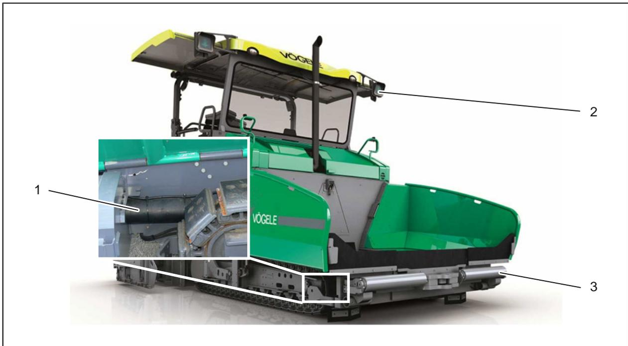
Рис. 2-104: Буферный ролик
