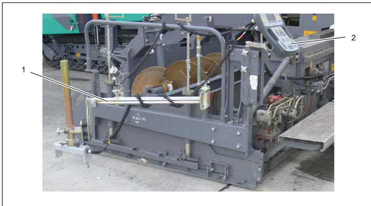
Рис. 6-26: Нивелировочное устройство NIVELTRONIC Plus®
