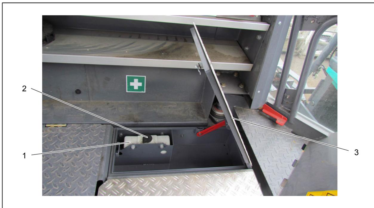
Рис. 2-70: Бак для стеклоочистительной жидкости
