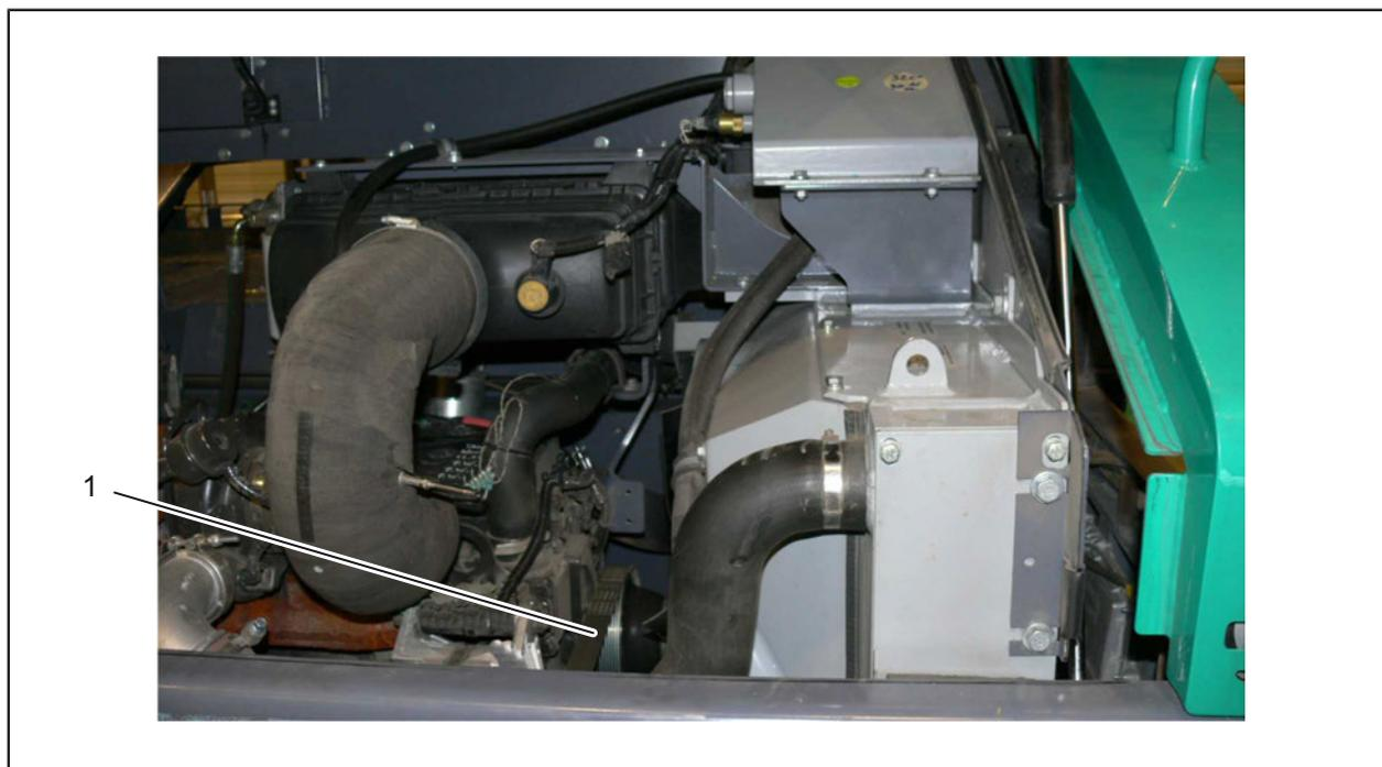
Рис. 4-7: Проверка приводного ремня
