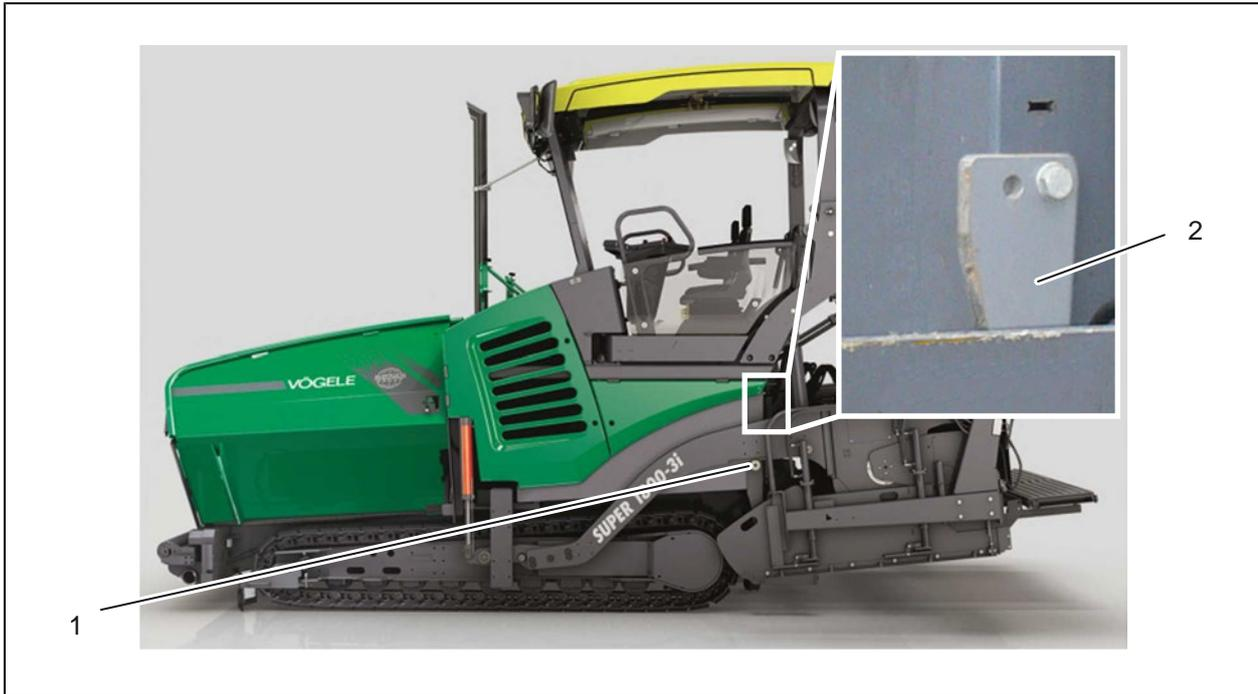
Рис. 2-123: Блокировка плиты
