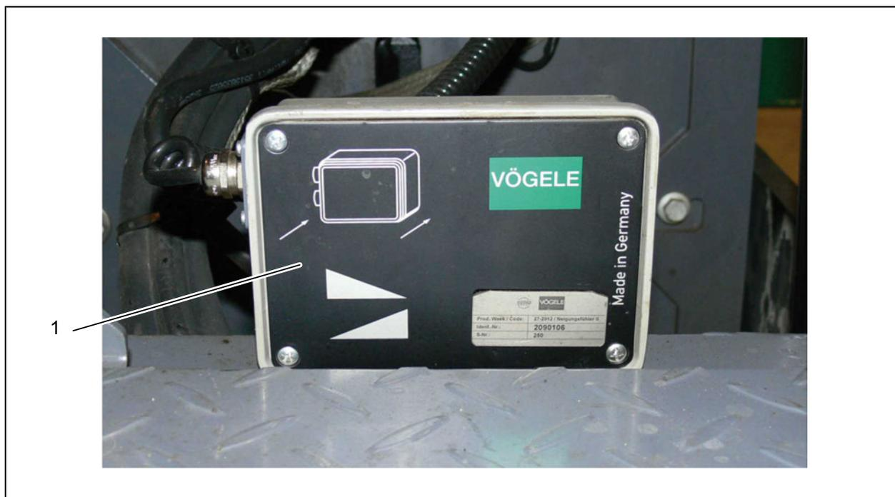
Рис. 2-115: Датчик уклона
