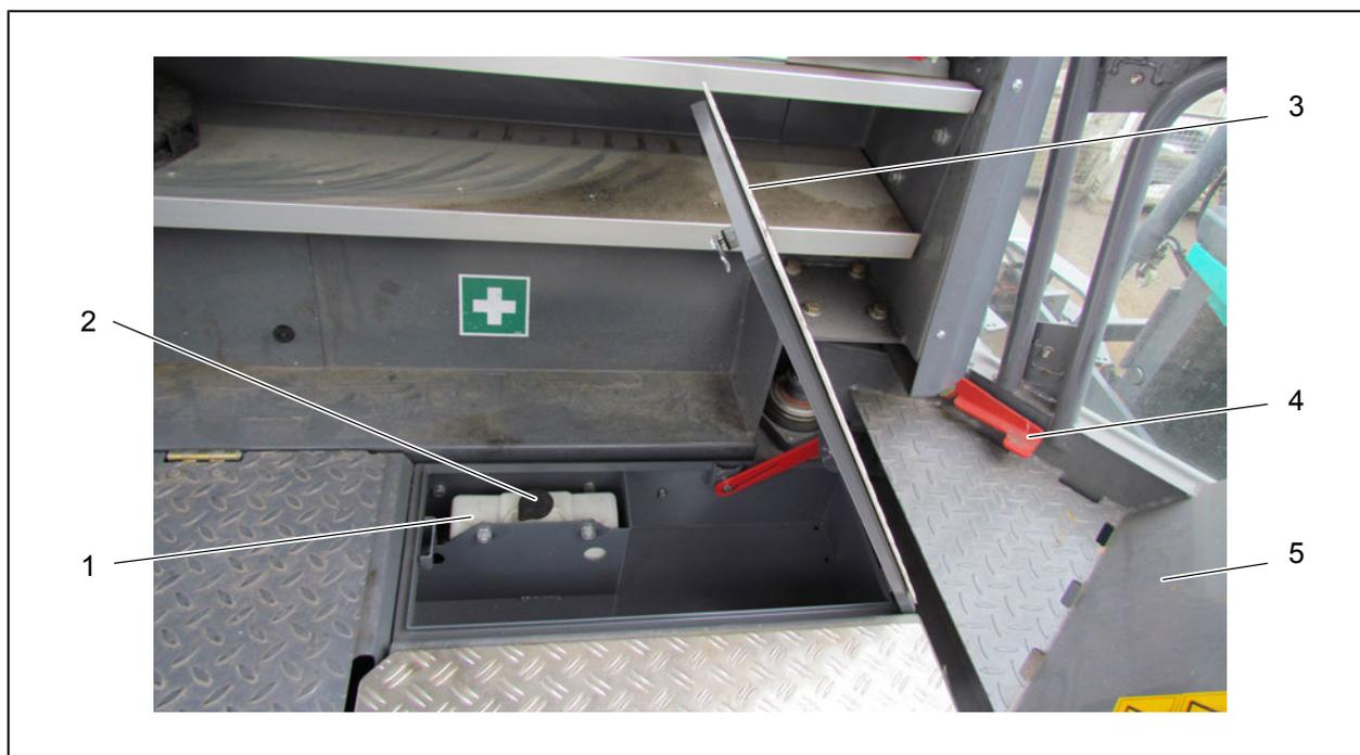
Рис. 4-2: Бак для стеклоочистительной жидкости
