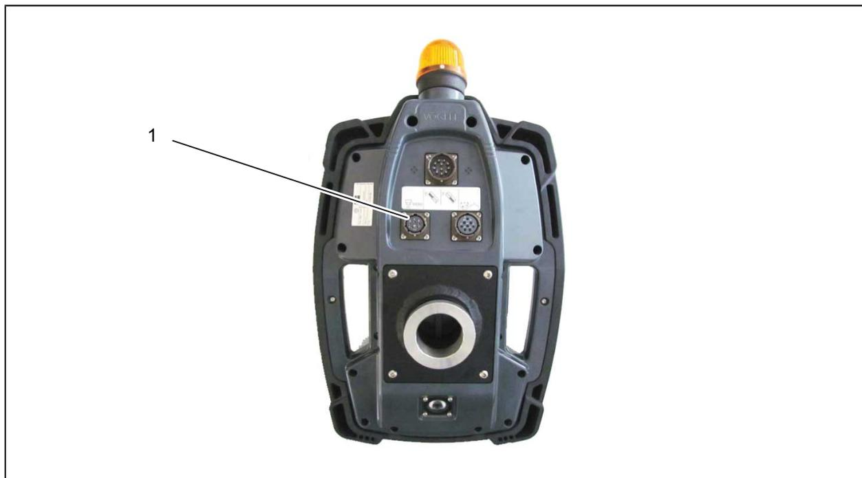
Рис. 2-68: Разъем для подключения нивелировочного датчика
