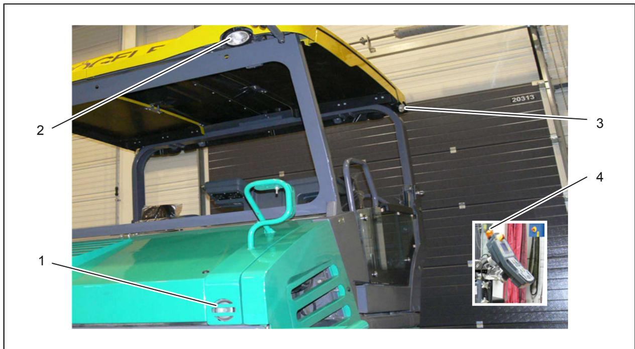
Рис. 2-5: Освещение и предупреждающее устройство
