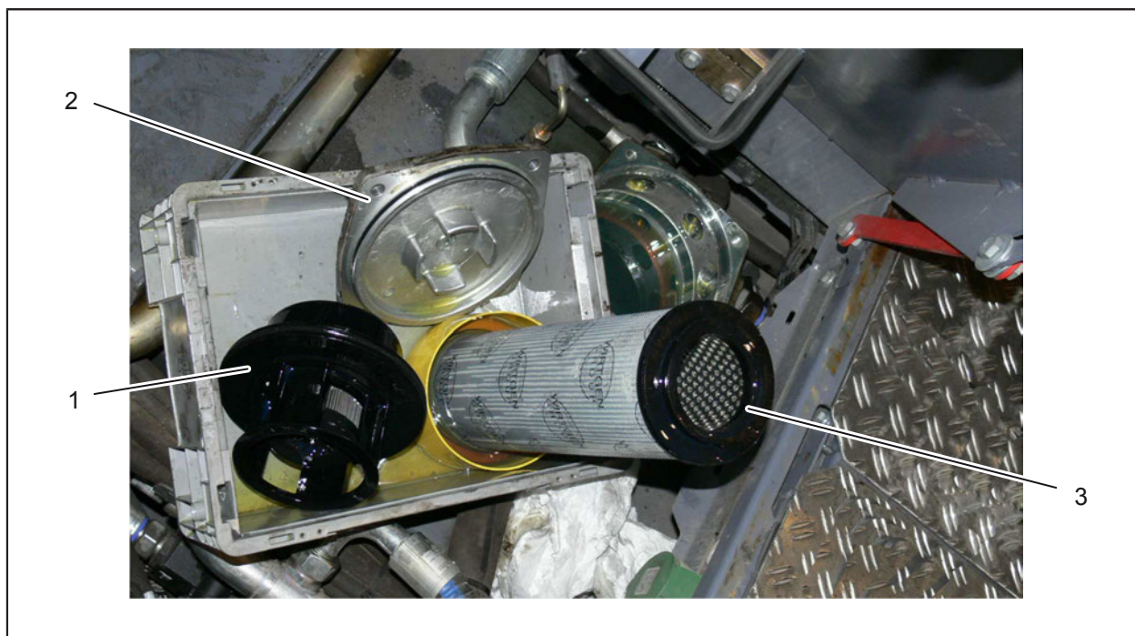
Sl. 4-20: Povratni usisni filter
