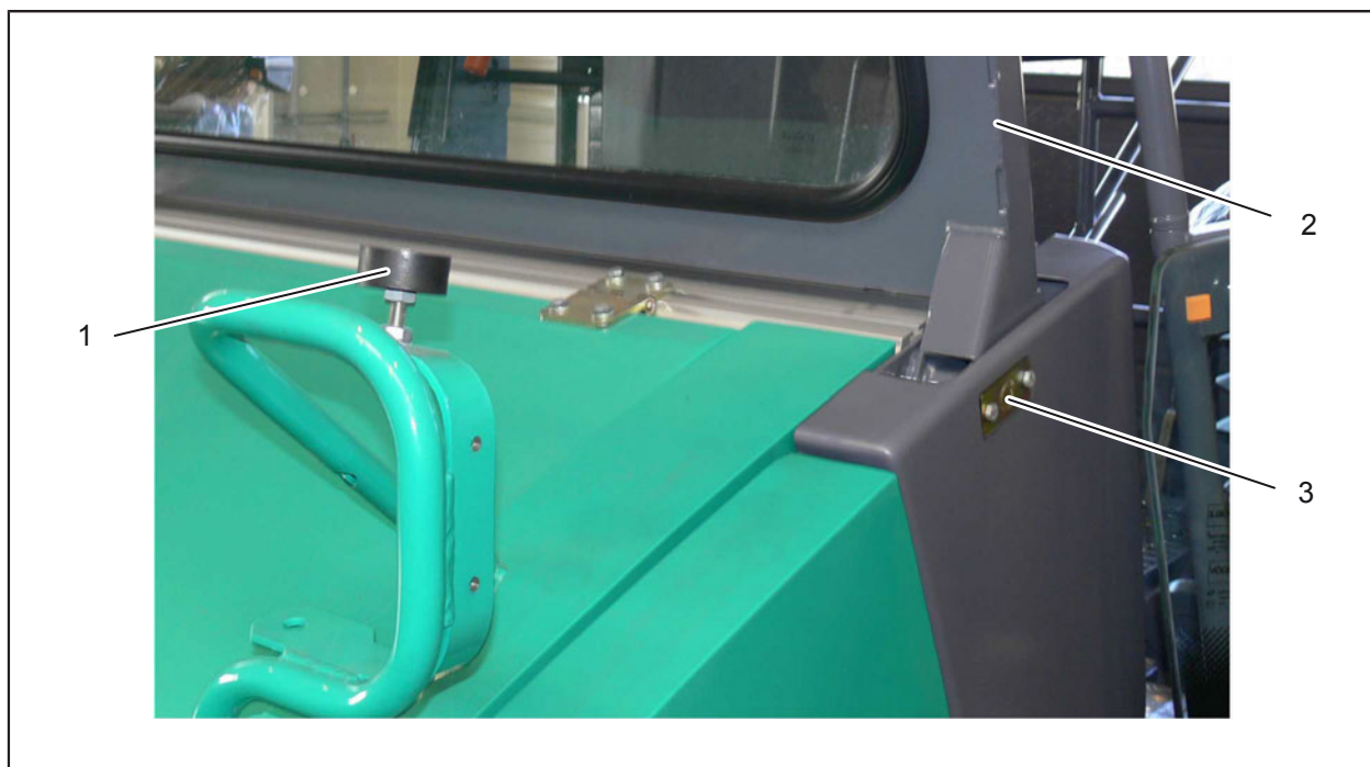
Sl. 6-5: Montaža okvira vetrobranskog stakla
