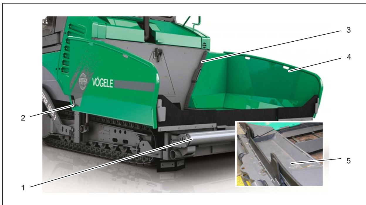
Sl. 2-105: Bunker za materijal
