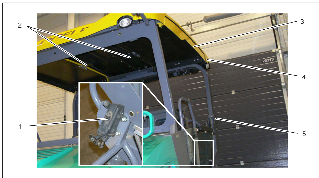
Sl. 2-69: Zaštitna nadstrešnica
