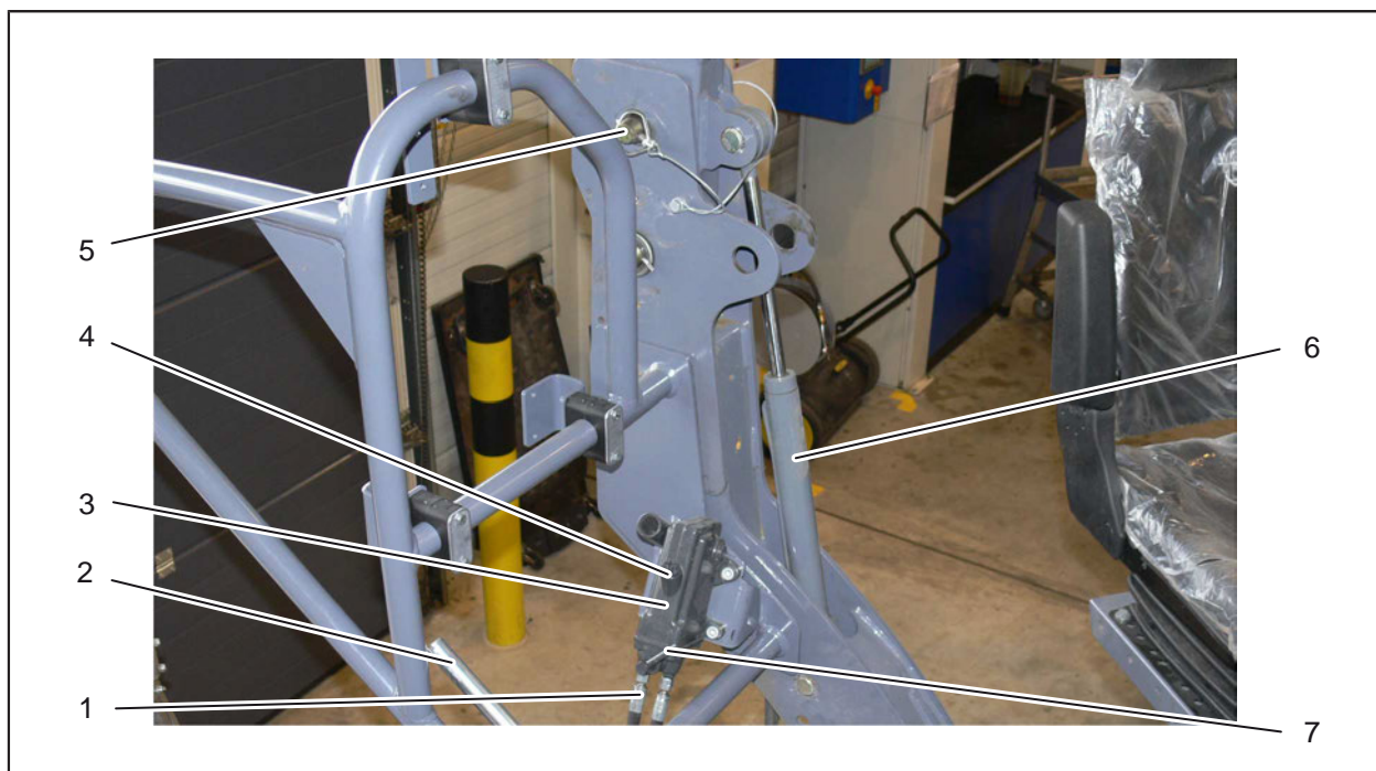
Sl. 6-3: Montaža ručne pumpe
