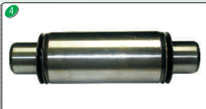
Pino e Bucha montado com as Arruelas de Vedação.
