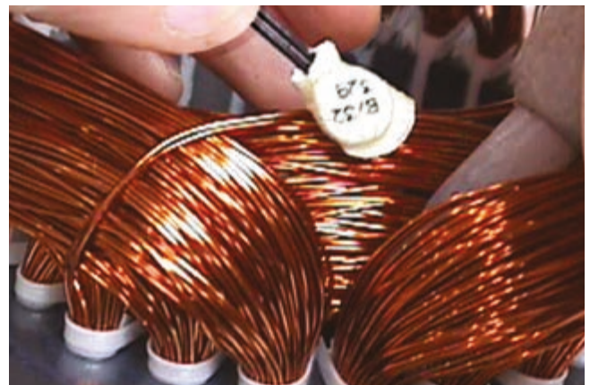
Figura 7.6 - Instalación del protector térmico bimetálico.
