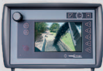
② Cámara dispuesta en el extremo de la cinta de carga
